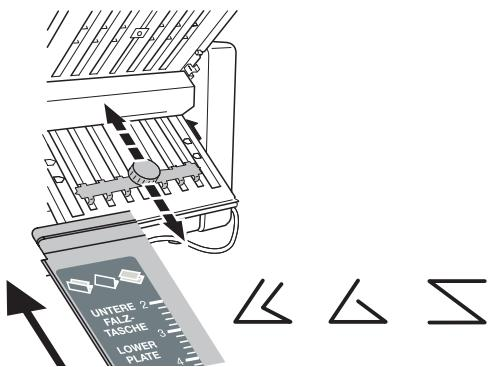
**DE** Unterer Falzanschlag einstellen. Die Falztasche so einschieben, das das Symbol der gewünschten Falzart oben steht.
