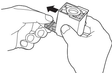
**DE** Den schwarzen Klammernstopper vom Flachklammernmagazin entfernen.
