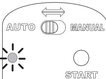
**DE** Deckel schließen. Bei neuem Flachklammernmagazin sind 5 bis 7 Leerheftungen notwendig bevor die erste Heftung erfolgt.
