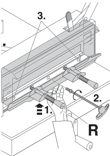
**DE** Mit der einen Hand die Messerwechselvorrichtung nach oben drücken (1.). Mit der anderen Hand die mittlere Messerschraube zuerst leicht festschrauben (2.), danach die beiden Messerschrauben links und rechts leicht festschrauben (3.)
