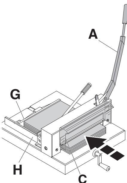
**IT** La leva di taglio (**A**) è **arretrata** all punto di partenza, alzare lo schermo di sicurezza (**C**). Posizionare essattamente le pile di carta sul margine posteriore (**G**) e sul margine laterale (**H**).
