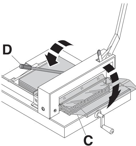
**IT** La leva di taglio (**A**) è **arretrata** all punto di partenza, alzare lo schermo di sicurezza (**C**). Posizionare essattamente le pile di carta sul margine posteriore (**G**) e sul margine laterale (**H**).
