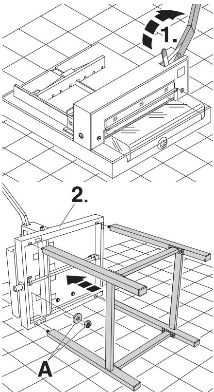
**DE** Untergestell (Zubehör) auspacken und nach separater beiliegender Anleitung zusammenschrauben.
