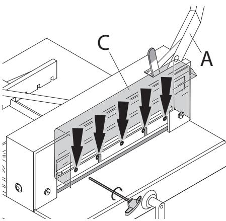
**DE** Messerhebel (**A**) nach oben führen und **arretieren**, Haube vorne (**C**) nach oben klappen, alle 5 Messerschrauben mit einem Drehmoment von 10Nm festdrehen.
