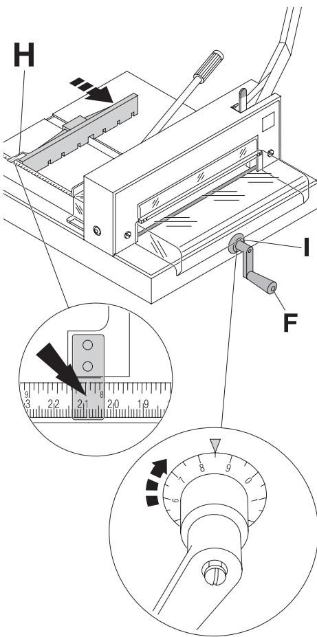
**IT** La regolazione della misura si ottiene usando l'anello graduato (**F**). Partire con la misura → dal margine posteriore. La misura viene visualizzata dalla scala laterale sinistra (**H**) (mm/inch). L'esatta regolazione si ottiene usando l'anello graduato (**I**).
