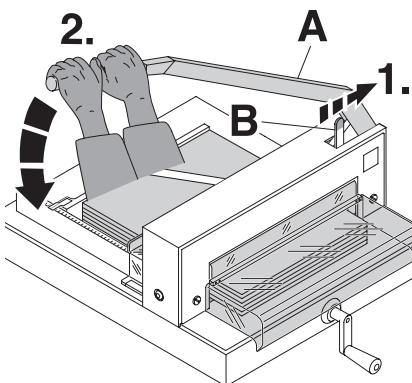
**RU** Снимите блокировку ножа (**B**) и опустите рычаг ножа (**A**), держа его обеими руками.
