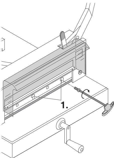
**DE** Restliche 2 Messerschrauben (1.) an den Langlöchern leicht festschrauben.
