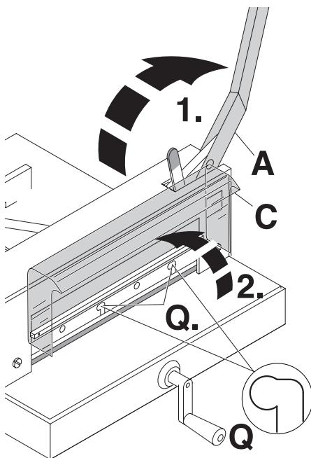
**DE** **Messerwechsel von der Vorderseite der Maschine vornehmen:** Messerhebel (A) nach oben führen und **arretieren**. Haube vorne (C) nach oben klappen. 2 Messerschrauben an den Langlöchern (Q) herausdrehen. (Werkzeug im Werkzeugsatz).
