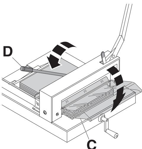
**DE** Handgriff für Papierpressung (**D**) vor jedem Schnitt nach links umlegen und mit einem leichten Ruck arretieren.
