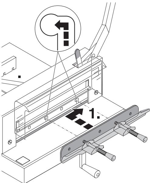
**RU** Установите заменяемый нож в держатель ножа, используя приспособление для замены ножа, подняв его вверх и сдвинув влево (1.) (смотрите рисунок А), выполняя эту процедуру, обе пружины в исходном положении. Если снимаете затупившийся нож, необходимо сжать обе пружины (смотрите рисунок В).
