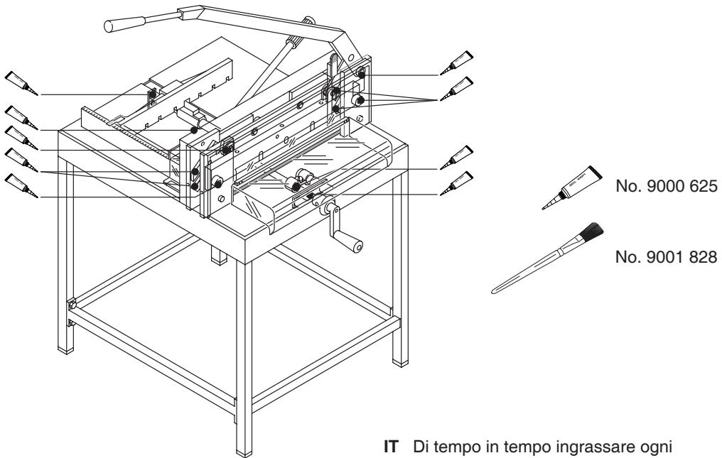
**IT** Di tempo in tempo ingrassare ogni componente mobile (usare grasso speciale per macchine da taglio). Prima della manutenzione spolverare ogni componente da polvere da carta oppure da grassi.
