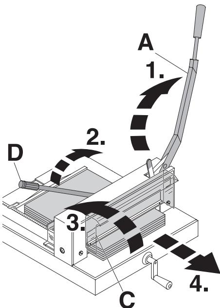
**RU** После реза верните рычаг ножа (**A**) назад в верхнее положение, чтобы он **заблокировался**. Поверните рычаг (**D**) вправо. Поднимите защищающий руки кожух (**C**) и уберите отрезанную бумагу
