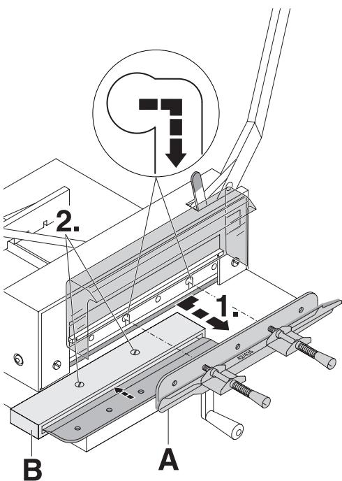
**DE** Das Messer mit Messerwechselvorrichtung (**A**) nach rechts schieben und nach unten entnehmen (1.). Messer in den dafür vorgesehenen Messerkasten (**B**) legen und festschrauben (2.).
