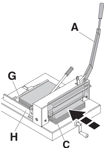
**RU** Рычаг ножа (**A**) заблокирован в верхнем положении. Поднимите передний кожух (**C**) и положите стопу бумаги на стол резака, точно расположив ее по заднему упору (**G**) и боковому упору (**H**) слева.
