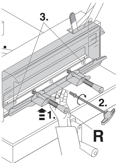
**RU** Прижмите приспособление для замены ножа рукой вверх (1.). Сначала, слегка закрутите средний винт крепления ножа другой рукой (2.), за тем два крайних винта левый и правый (3.). Удалите приспособление для замены ножа (R) (открутите обе рукоятки).
