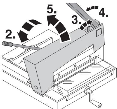
**RU** Рычаг ножа (**A**) не должен падать самопроизвольно. При необходимости затяните винт с шестигранной головкой.
