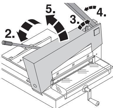
**PT** A alavanca da lâmina (A) nunca deve cair automaticamente para baixo. Se necessário apertar o parafuso hexagonal.
