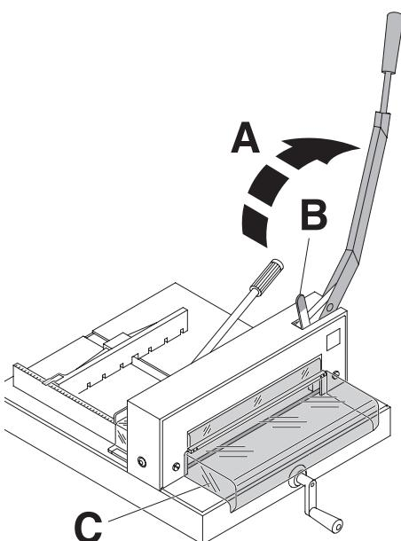
**RU** После выполнения каждого реза рычаг ножа (**A**) необходимо вернуть в верхнее положение, чтобы нож заблокировался. Устройство блокирования ножа (**B**) фиксирует нож в верхнем положении. Процедуру реза можно выполнить только тогда, когда защищающий руки кожух (**C**) опущен вниз до упора, и устройство блокировки ножа (**B**) открыто.
