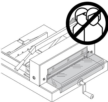
**RU** Машина предназначена для реза стопы бумаги в соответствии с задаваемым размером. Конструкция машины предусматривает работу только «одним оператором»!
