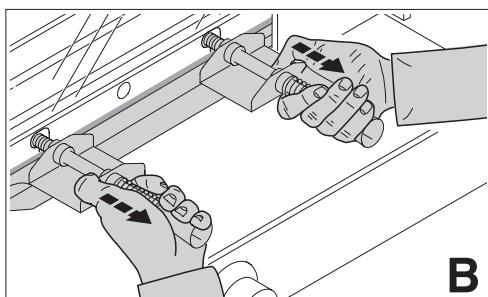
**DE** Austauschmesser mit aufgeschraubter Messerwechselvorrichtung ganz nach oben und nach links in den Messerträger schieben (1.) (siehe Bild A) dabei die beiden Federn nach hinten drücken. Das Drücken der beiden Federn ist nur nötig, wenn ein nachgeschliffenes Messer eingebaut wird (siehe Bild B).
