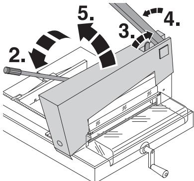
**NL** Het meshendel (**A**) mag nooit uit zichzelf naar beneden vallen. Wanneer nodig de zeskantmoer vastdraaien verwijder de bovenkap (**K**) verwijder de 2 schroeven (**P**) van de bovenkap (1.). Sluit de klem (2.). Mesblokkering losmaken (3.) en beweeg de meshendel (4.) een klein stukje naar links, verwijder de bovenkap (5.).
