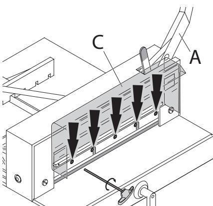
**RU** Отведите рычаг ножа (**A**) вверх и **зафиксируйте его**. Поднимите передний кожух (**C**), и затяните все 5 винтов с моментом затяжки 10 Нм.
