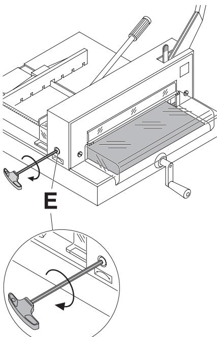
**RU** Выкрутите винт регулировки глубины опускания ножа (**E**) полностью вправо (-).
