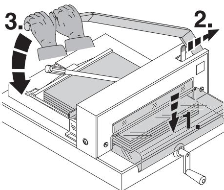
**RU** Закройте передний защитный кожух (1.) и откройте блокировку ножа (2.). Опустите рычаг ножа, держа его обеими руками (3.).
