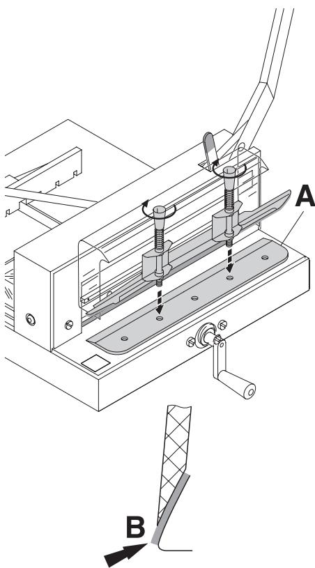
**DE** Austauschmesser vorsichtig aus Messerkasten nehmen und mit Messerwechselinheit verschrauben! (A).
