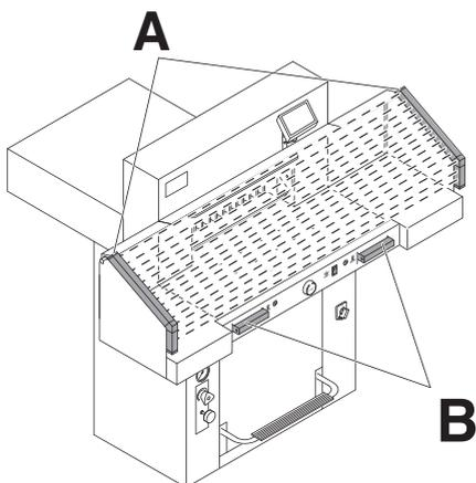
En ce qui concerne les éléments de coupe en mouvement, les cellules photoélectriques (**A**) et une commande bi-manuelle temporisée (**B**) vous en protègent!
