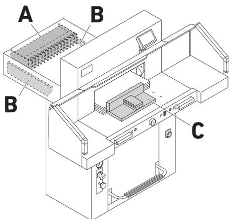
La pile de papier peut être placée contre la butée arrière (A) et contre la butée latérale gauche ou droite (B). Utilisez l'équerre d'empilage (C), fournie pour déplacer la pile de papier.
