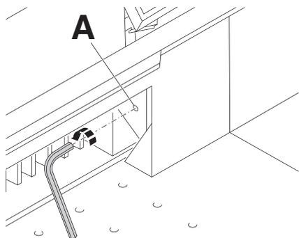
Couper une pile de papier pour tester la profondeur de coupe. Si la dernière ou plusieurs feuilles ne sont pas totalement coupées, tourner la vis de réglage de la profondeur de coupe (**A**) vers la gauche, graduellement et toujours d'1/6 de tour à la fois, jusqu'à ce que toutes les feuilles soient coupées. (Si la lame s'enfonce trop dans la réglette, la durée de vie de la lame s'en trouve considérablement réduite).
