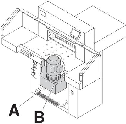
Toutes les 1000 heures de fonctionnement ou une fois par an, et si la machine est fortement sollicitée, deux fois par an. Graisser et huiler le massicot suivant le plan.
