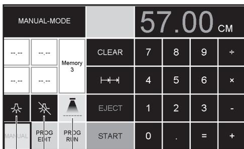
En appuyant sur la touche LED (5) et en la maintenant enfoncée, il est possible de régler la luminosité en continu.
