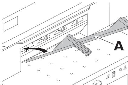
Monter la protection de la lame (A).
