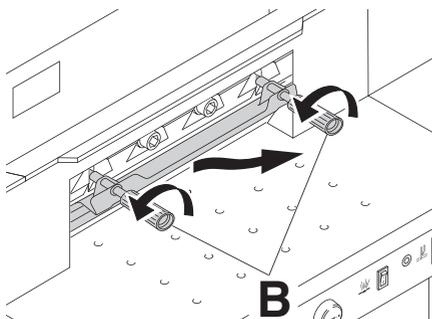
Desserrer légèrement les deux poignées (B) en même temps et ôter la lame avec sa protection.
