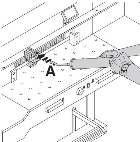
Lubrificare settimanalmente la guida dell'antiretro con Lubrificare con un ingrassatore.
