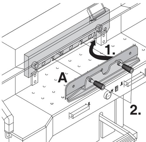
Posizionare la lama da sostituire, con l'utensile di sostituzione lama (A) montato (1.), nel portalamina, e spingere la lama verso l'alto fino alla parte superiore e avvitare la nel suo alloggiamento con le maniglie (2.).
