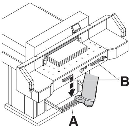
Nella fase di taglio la squadra di battuta pressa automaticamente. Con il pedale (A) la carta può essere presata in avanti. Il taglio viene attivato premendo contemporaneamente entrambi i due attuatori del sistema di comando bimanuale (B).
