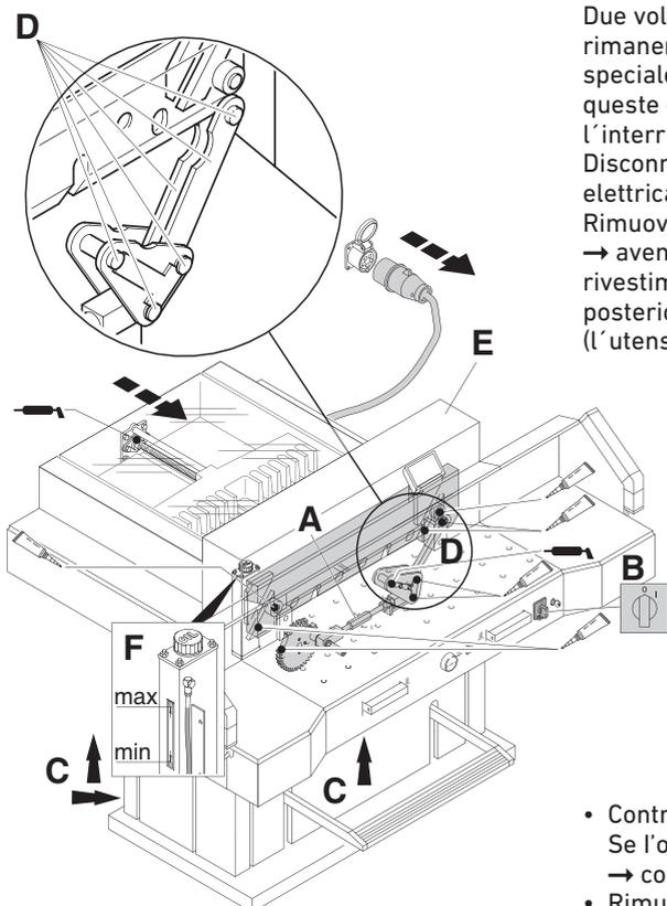
Due volte all'anno ingrassare le parti rimanenti (vedi figura a lato) (usare grasso speciale per macchine da taglio). Per eseguire queste operazioni di manutenzione regolare l'interruttore principale alla posizione "0" (B). Disconnettere la macchina dall'alimentazione elettrica.
