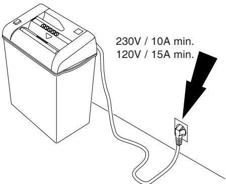
**D** Freier Zugang zum Netzanschluß
