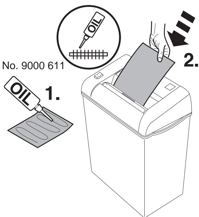
إذا انخفضت قدرة الماكينة على التقطيع يعد تفريغ درج التقطيع قم بتنزيت آلية التقطيع
