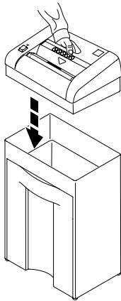
**D** Maschine in den Auffangbehälter bzw.
