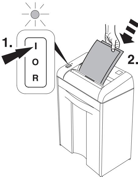
تكون الآلة جاهزة التشغيل إذا كان مفتاح التشغيل على وضع "I". يضيء مؤشر أخضر (1). تشغيل تلقائي عند إدخال الورق أو DVD أو CD أو بطاقات الائتمان (2). توقف تلقائي عند الانتهاء من قطع الورق و DVD و CD و بطاقات الائتمان. يقف التشغيل عند عدم الاستخدام لفترة طويلة. بعد ذلك لا تستهلك الآلة أية طاقة كهربائية.
