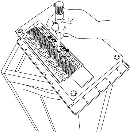
**RUS** Периодически очищайте режущий механизм аппарата.
