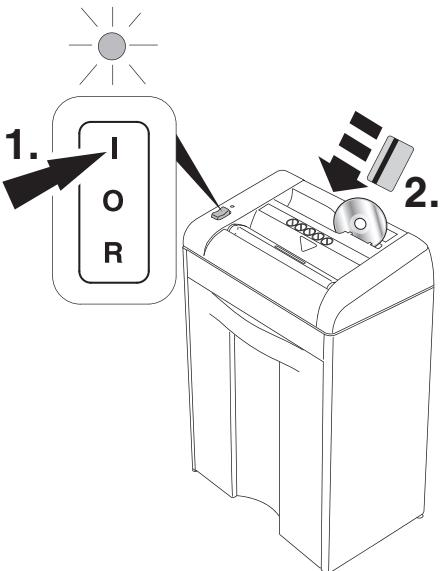
**E** Presione el botón principal en posición "I": lista para su funcionamiento. Se iluminará el indicador óptico de color verde (1.). Se pondrá en marcha automáticamente al insertar papel, CDs/DVDs y/o tarjetas de crédito 2.). Se detendrá automáticamente si no se introduce más papel CDs/DVDs y/o tarjetas de crédito. Cuando no se utilice la máquina por largo tiempo tiene que estar desconectada. Con ello, no hay habrá ningún consumo.
