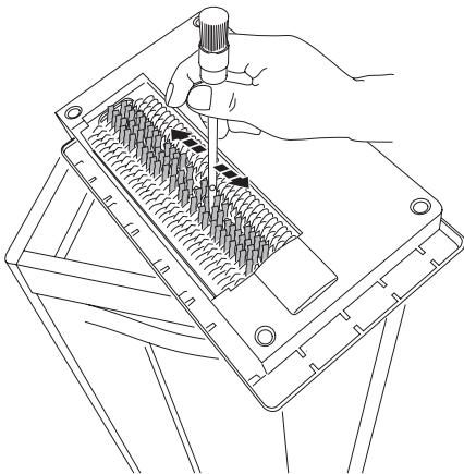
**RU** Периодически очищайте режущий механизм аппарата.
