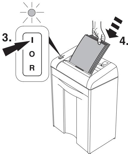
**GR** Πιέστε το κουμπί αναστροφής (1.) και αφαιρέστε το χαρτί (2.). Επαναφέρετε τη συσκευή σε κανονική λειτουργία τοποθετώντας το διακόπτη στη θέση „I“ (3.). Τροφοδοτήστε ξανά το χαρτί σε μικρότερες ποσότητες (4.).
