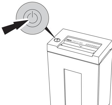
**PT** Inicia automaticamente quando o papel é inserido. O standby automático que desliga depois de 15 minutos. A máquina pode ser desligada a qualquer momento pressionando o interruptor durante 2 segundos. O indicador LED verde apaga-se. Não haverá mais consumo de energia. Não vai mais existir consumo de energia. Entre estes 15 minutos a destruidora de papel, usa o seguinte watt/hora energia.
