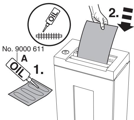
إذا شعرت بتدني حدة القص أو بعد إمتلاء كل كيس للتجميع قم بتنزيت أداة القص (شاهد الصورة). في حالة قص الشريط الجانبي استخدم المزيت (A)! في حالة تقطيع الجزيئات استخدام أوراق الزيت (B) أو المزيت (A)! لمعرفة رقم طلب القطعة أنظر صفحة 21.
