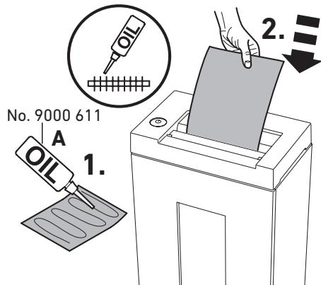
إذا شعرت بتدني حدة القص أو بعد إمتلاء كل كيس للتجميع قم بتنبيت أداة القص (شاهد الصورة). في حالة قص الشريط الجانبي استخدم المزيت (A)! في حالة تقطيع الجزيئات استخدم أوراق الزيت (B) أو المزيت (A)! لمعرفة رقم طلب القطعة انظر صفحة 19
