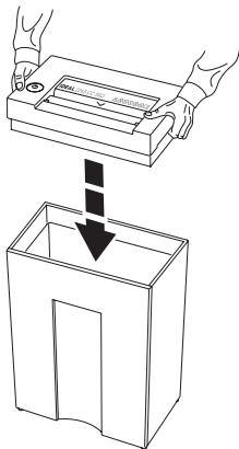
**RU** Установите механизм на корпус аппарата.
