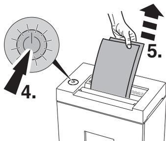
**PT A máquina pára automaticamente se tiver demasiado or papel inserido.**
