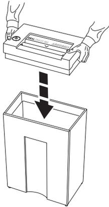
**RU** Установите механизм на корпус аппарата.
