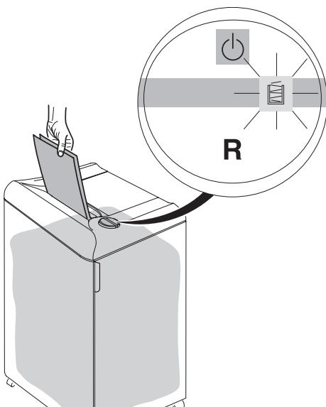
**RU** При заполнении пластикового мешка аппарат остановится автоматически. Должен загореться индикатор "мешок заполнен". Замените пластиковый мешок. (смотри стр. 10 и 11).
