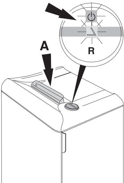
**NL** Automatische stop als de veiligheidsklep (A) geopend wordt (Symbolen ↗ en ⚡ knipperen afwisselend.)
