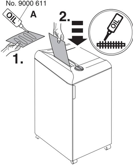
عند انخفاض مستوى أداء الآلة أو بعد امتلاء وعاء التجميع المرجو دهن أداة القص بالزيت (أنظر الصورة). المرجو استخدام مزيتة (A) عند القص على شكل أشروطة! في حالة القص على شكل أجزاء المرجو استخدام أوراق زيتية (B) أو مزيتة (A)!
