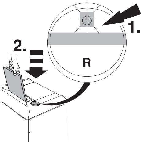
**DE** Schalter drücken (1.) : grünes Licht leuchtet, Maschine betriebsbereit. Autom. Anlauf bei Papierzufuhr. Autom. stand/by Abschaltung nach 30 Minuten. Maschine kann jederzeit durch 2 sec. langes Drücken des Schalters ausgeschaltet werden. Grüne Kontrollleuchte erlischt. Danach verbraucht die Maschine keinen Strom mehr.
