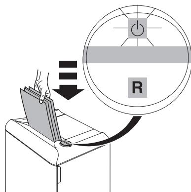
**RU** Останавливается автоматически при превышении количества уничтожаемой бумаги. Реверс включается автоматически, если произошел затор бумаги. (Индикатор «ON/OFF» замигает).
