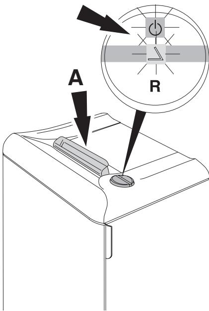
**DE** Autom. Stopp wenn Sicherheitsklappe (**A**) geöffnet wird (Symbole und blinken abwechselnd).
