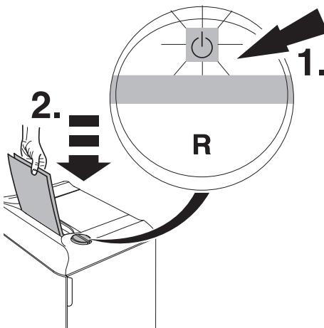
**ES** Presionar botón (1.) a luz verde indica que está listo para funcionar. Inicio automático con el indicador en verde en caso de inserción de papel. Modo de espera automático que se apaga tras 30 minutos. La máquina puede apagarse en cualquier momento pulsando la tecla durante 2 segundos. El indicador LED verde se apaga . Con ello, no hay habrá ningún consumo.
