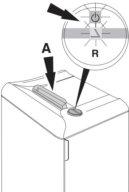
**RU** Аппарат автоматически остановится, если шторка безопасности (A) открыта (индикаторы  $\Delta$  и  $\cup$  будут загораться поочередно). Закройте шторку безопасности и нажмите кнопку  $\cup$  - аппарат продолжит уничтожать бумагу. Машина может работать некоторое время в реверсном направлении с открытой шторкой безопасности, если Вам необходимо удалить обрезки бумаги или произошло ее замятие.
