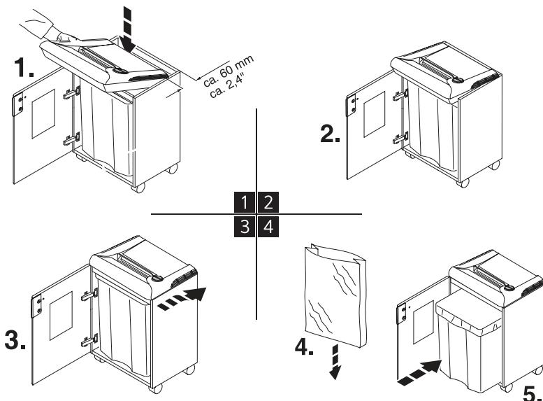
커버를 열고 기기 헤드 부분을 장착하십시오. 장착시 장착 그림을 참고해주시고, 손가락 부상에 각별히 유의하시기 바랍니다. 장착 후에는 파지의 분진 발생을 줄이고 폐기시 용이함을 위해 동봉된 비닐 봉투를 씌워서 사용하십시오.
