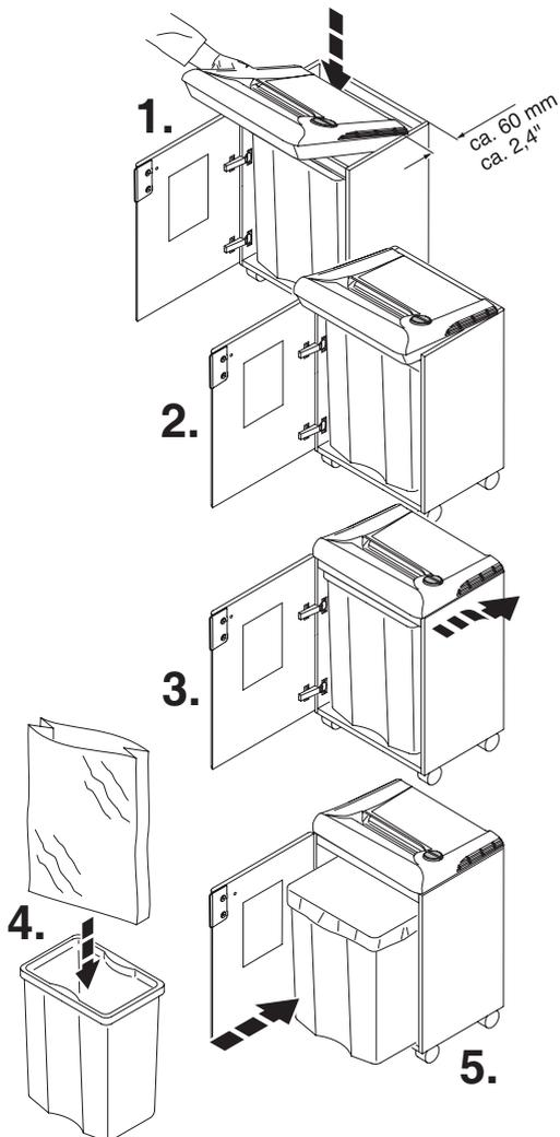
**DE** Türe öffnen, Maschine auf Schrank aufsetzen und loslassen.
