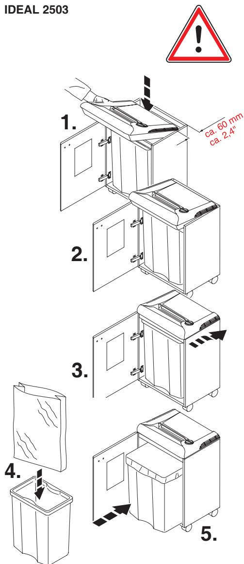
**D** Türe öffnen, Maschine auf Schrank aufsetzen und loslassen. (Siehe Bild links)
