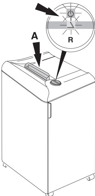
**RU** Аппарат автоматически остановится, если шторка безопасности **(A)** открыта (индикаторы  $\blacktriangle$  и  $\odot$  будут загораться поочередно). Закройте шторку безопасности и нажмите кнопку  $\odot$  - аппарат продолжит уничтожать бумагу.
