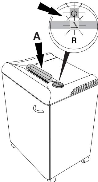
**NL** Automatische stop als de veiligheidsklep (A) geopend wordt (Symbolen  $\Delta$  en  $\odot$  knipperen afwisselend.)
