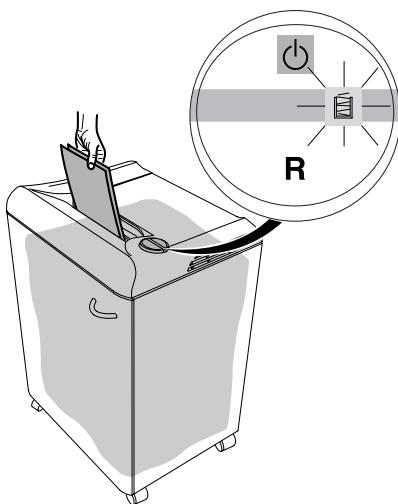
**RUS** При заполнении пластикового мешка аппарат останавливается автоматически. Должен загореться индикатор «мешок заполнен». Замените пластиковый мешок. (смотри стр. 9 и 10).
