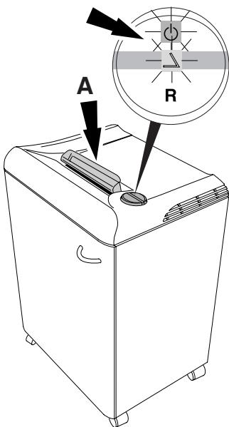
**RUS** Аппарат автоматически остановится, если шторка безопасности (**A**) открыта (индикаторы  $\Delta$  и  $\odot$  будут загораться поочередно). Закройте шторку безопасности и нажмите кнопку  $\odot$  - аппарат продолжит уничтожать бумагу.
