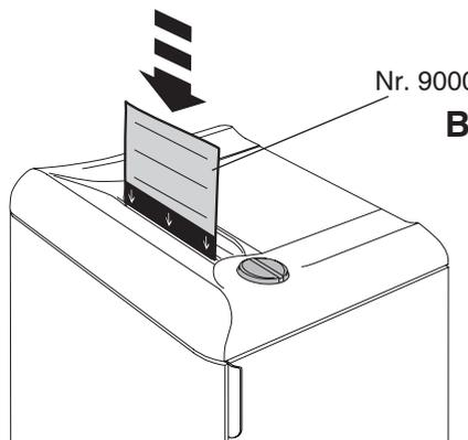
**DE** Bei jedem gefüllten Auffangbehälter oder bei nachlassender Schneidleistung Schneidwerk ölen, bei MC- / SMC-Schneidwerken häufiger ölen! Bei allen Aktenvernichtern Öler (A) verwenden, alternativ bei CC-Schneidwerken die Ölblätter (B) verwenden!
