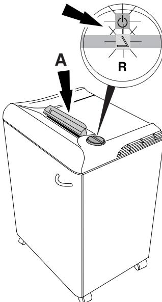
**NL** Automatische stop als de veiligheidsklep (A) geopend wordt (Symbolen  $\Delta$  en  $\circlearrowright$  knipperen afwisselend.)
