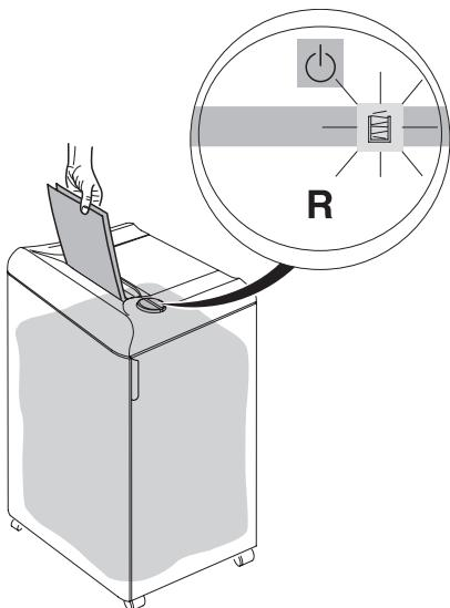
**RU** При заполнении пластикового мешка аппарат останавливается автоматически. Должен загореться индикатор «мешок заполнен» Замените пластиковый мешок. (смотри стр. 11 и 12).
