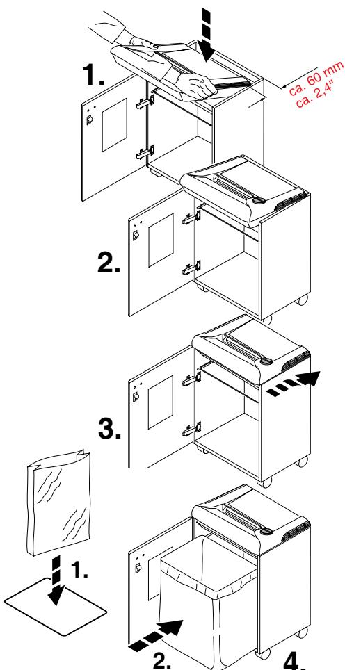
**D** Türe öffnen, Maschine auf Schrank aufsetzen und loslassen. (Siehe Bild links) Auf Finger achten!
