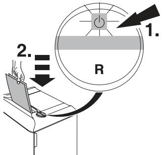
전원버튼 (1)을 누르면 녹색 LED가 점등되며, 기기의 작동 준비가 완료됩니다. 점등 후 세단용지를 투입하시면 세단이 자동으로 시작되고, 세단이 완료되면 작동이 멈추고 대기 상태로 전환 됩니다.
