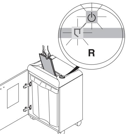
**RUS** При отсутствии бумаги аппарат автоматически останавливается.
