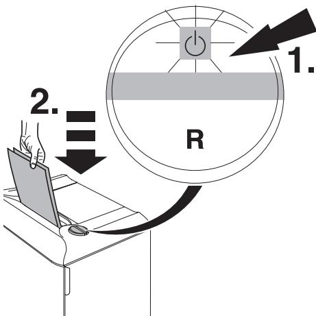
**RU** Нажмите переключатель : загорится зеленый светодиод, машина снова готова к работе. Машина автоматически начнет работать, если поместить бумагу в приемный слот. Машина автоматически переходит в режим ожидания через 30 минут. Машина может быть выключена в любое время, удерживая выключатель в течение 2 секунд. Зеленый светодиод не горит. Не будет никакого потребления электрэнергии.
