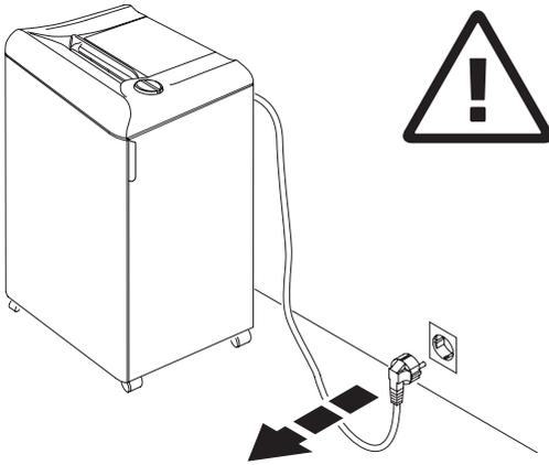
**DE** Bei der Reinigung Netzstecker ziehen!
