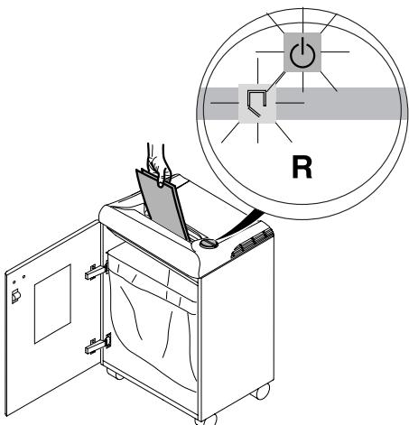
**RUS** При открытии дверцы аппарат останавливается автоматически.
