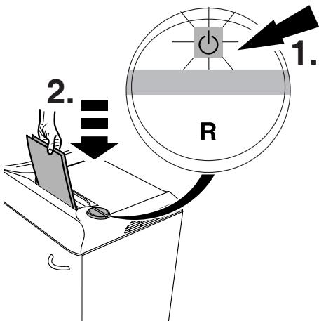
**D** Schalter auf Position ⏪ : grünes Licht leuchtet, Maschine betriebsbereit. Automatischer Anlauf bei Papierzufuhr.
