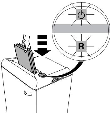
**RUS** Останавливается автоматически при превышении количества уничтожаемой бумаги. Реверс включается автоматически, если произошел затор бумаги. (Индикатор «ON/OFF» мигает.
