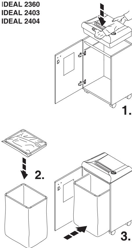
**D** Türe öffnen, Maschine mit Bedienfeld nach vorne aufsetzen! Auf Finger achten!
