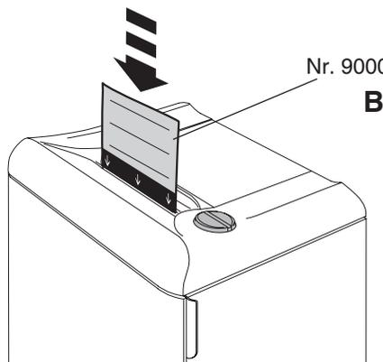
**DE** Bei nachlassender Schneidleistung oder nach jedem gefüllten Auffangbehälter Schneidwerk ölen! (siehe Bild)
