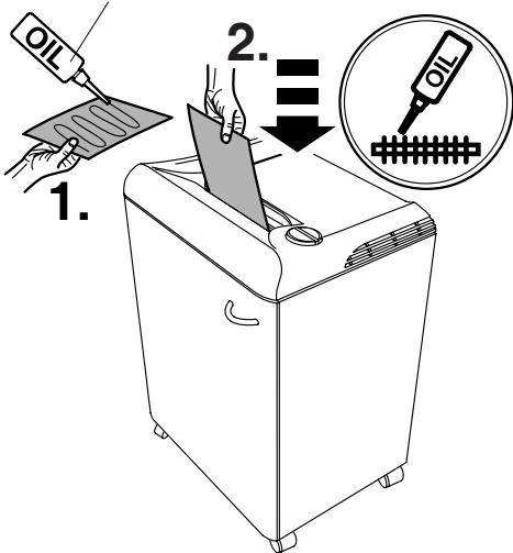
**D** Bei nachlassender Schneidleistung oder nach jedem gefülltem Auffangsack Schneidwerk ölen! (siehe Bild)
