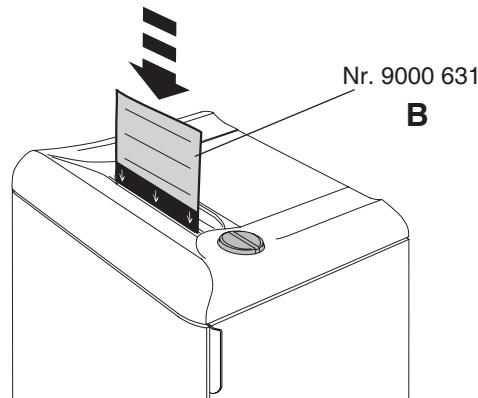
عند انخفاض مستوى أداء الآلة أو بعد امتلاء وعاء التجميع المرجو دهن أداة القص بالزيت (انظر الصورة).
