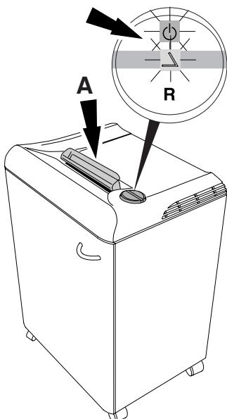
**D** Autom. Stopp wenn Sicherheitsklappe (**A**) geöffnet wird (Symbole und blinken abwechselnd). Sicherheitsklappe schließen auf Schalter drücken, Papier wird vernichtet.
