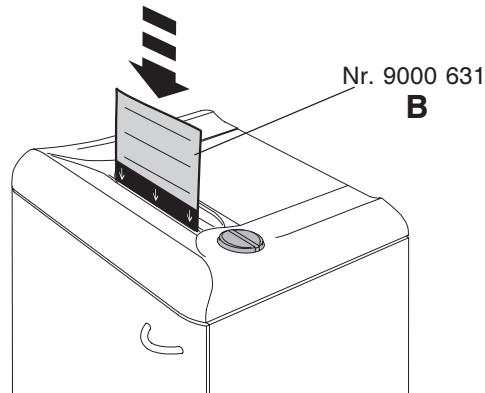
**D** Bei nachlassender Schneidleistung oder nach jedem gefüllten Auffangsack Schneidwerk ölen! (siehe Bild)
