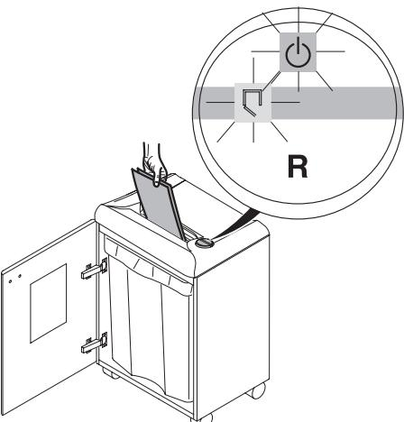
**RUS** При отсутствии бумаги аппарат автоматически останавливается.
