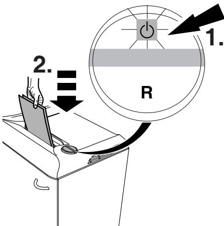
**RUS** Нажмите кнопку ⏪ - должен загореться зеленый индикатор. Теперь аппарат готов к работе. При подаче бумаги аппарат включится автоматически.
