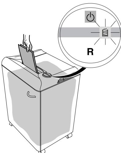
**RUS** При заполнении пластикового мешка аппарат останавливается автоматически. Должен загореться индикатор «мешок заполнен». Замените пластиковый мешок. (смотри стр. 8 и 9).
