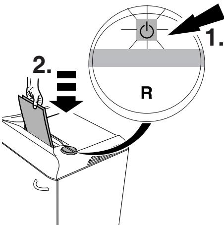
**D** Schalter ⏪ drücken (1.) : grünes Licht leuchtet, Maschine betriebsbereit. Autom. Anlauf bei Papierzufuhr. Autom. stand/by - Abschaltung nach 30 Minuten. Maschine kann jederzeit durch 2 sec. langes Drücken des ⏪ Schalters ausgeschaltet werden. Grüne Kontrollleuchte ⏪ erlischt. Danach verbraucht die Maschine keinen Strom mehr.
