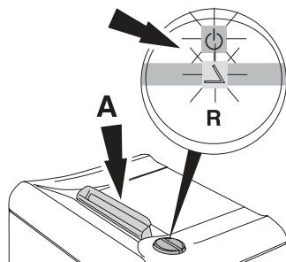
안전커버가 열릴 경우 경고 표시 LED가 깜빡이며 기기가 작동을 멈춥니다. 안전커버를 닫아 주시고 을 눌러 주시면 다시 정상 작동 합니다. 만약, 종이 걸림이 발생시 안전 커버를 열고 역회전 버튼을 누르시면 파지를 제거 하실 수 있습니다.
