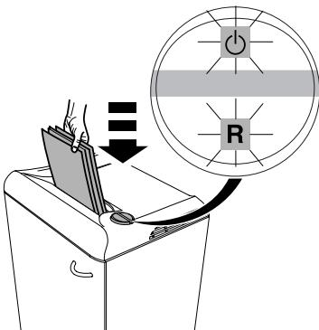
**RUS** Останавливается автоматически при превышении количества уничтожаемой бумаги. Реверс включается автоматически, если произошел затор бумаги. (Индикатор «ON/OFF» ⏹ замигает).
