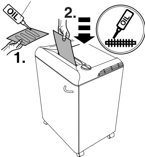
**D** Bei nachlassender Schneidleistung oder nach jedem gefülltem Auffangsack Schneidwerk ölen! (siehe Bild)
