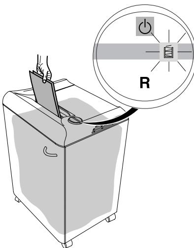
**RUS** При заполнении пластикового мешка аппарат остановится автоматически. Должен загореться индикатор «мешок заполнен» Замените пластиковый мешок. (смотри стр. 10 и 11).
