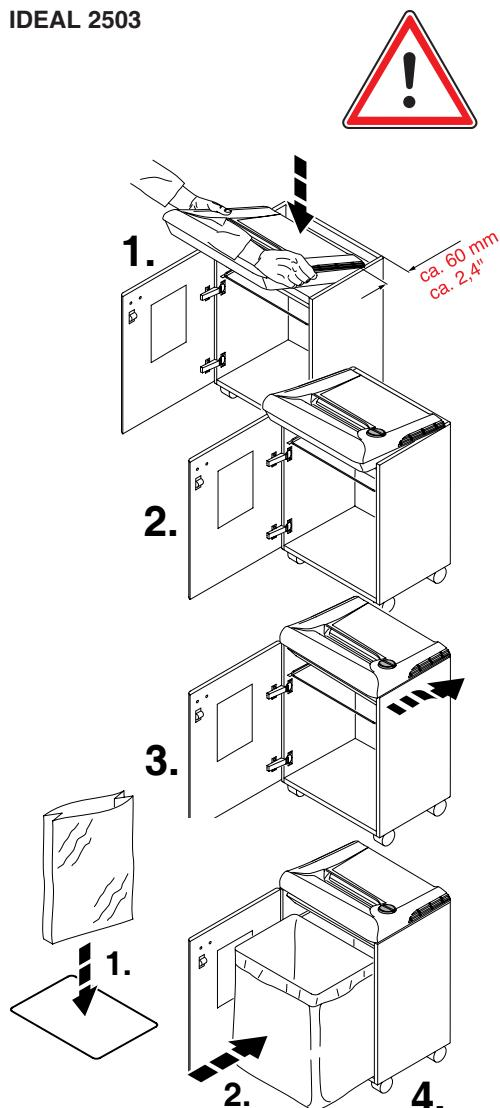
**D** Türe öffnen, Maschine auf Schrank aufsetzen und loslassen. (Siehe Bild links)
