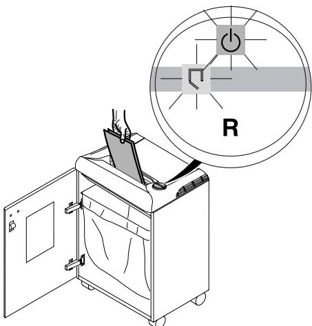
**RUS** При открытии дверцы аппарат останавливается автоматически.
