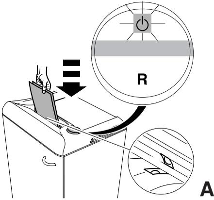
**RUS** Бумага установлена по центру приемного устройства? (фотодатчик) **(A)**
