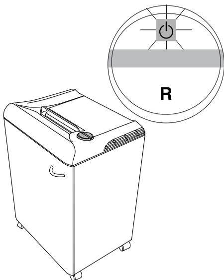
**RUS** При отсутствии бумаги аппарат автоматически останавливается.
