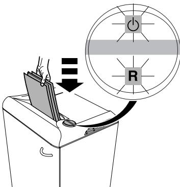
**RUS** Останавливается автоматически при превышении количества уничтожаемой бумаги. Реверс включается автоматически, если произошел затор бумаги.
