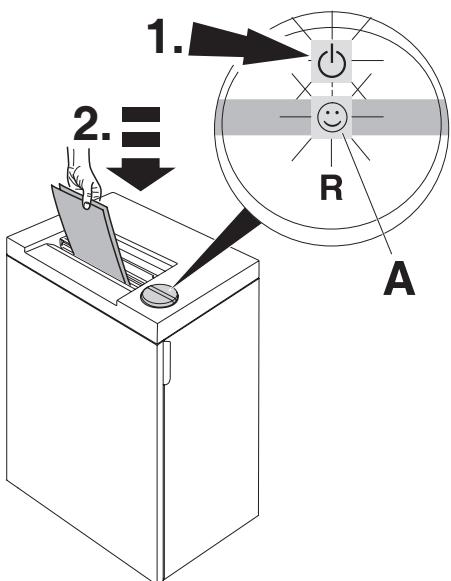
**SV** Tryck på knappen (1.). Grönt ljus visar "klar att använda", startar automatiskt när papper förs in (2.). Automatiskt "standby"-läge som stängs av efter 15 minuter. Maskinen kan stängas av genom att in knappen. Grön diod när kontrollampen är avstängd. Då drar inte maskinen någon mer ström.
