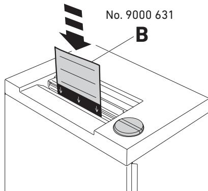
**DE** Bei jedem gefüllten Auffangbehälter oder bei nachlassender Schneidleistung Schneidwerk ölen, bei MC- / SMC-Schneidwerken häufiger ölen! Bei allen Aktenvernichtern Öler (**A**) verwenden, alternativ bei CC-Schneidwerken die Ölblätter (**B**) verwenden!
