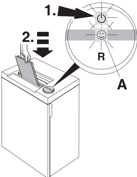
**NL** Schakelaar indrukken (1.) : groen licht gaat aan, machine is bedrijfsklaar. Start automatisch zodra papier wordt ingevoerd (2.). Automatische standby schakelt naar 15 minuten uit. De machine kan op elk gewenst moment worden uitgeschakeld door op de knop te drukken. Groene LED controlelampje is uit. De machine verbruikt dan geen stroom meer.
