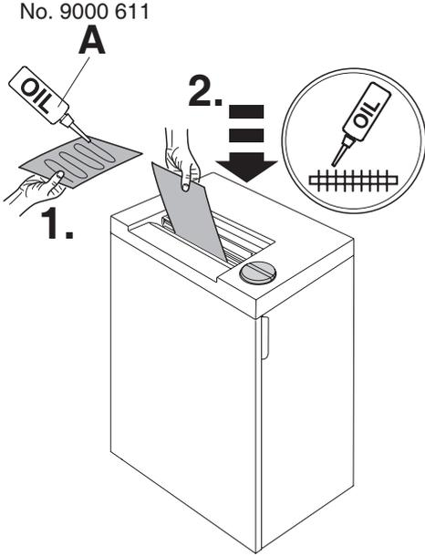
عند انخفاض مستوى أداء الآلة أو بعد امتلاء وعاء التجميع المرجو دهن أداة القص بالزيت (أنظر الصورة). المرجو استخدام مزيتة (A) عند القص على شكل أشرطة؛ في حالة القص على شكل أجزاء المرجو استخدام أوراق زيتية (B) أو مزيتة (A)!
