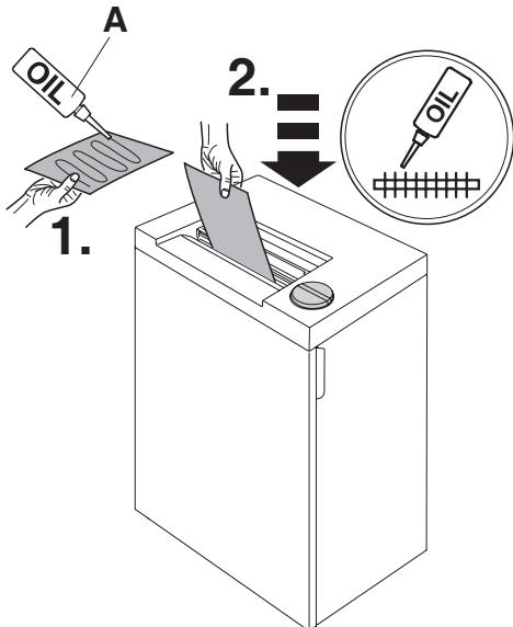
**Partikelschnitt/Particle cut/Coupe croisée/
