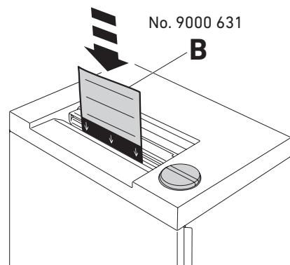
عند انخفاض مستوى أداء الآلة أو بعد امتلاء وعاء التجميع المرجو دهن آلة القص بالزيت (انظر الصورة).
