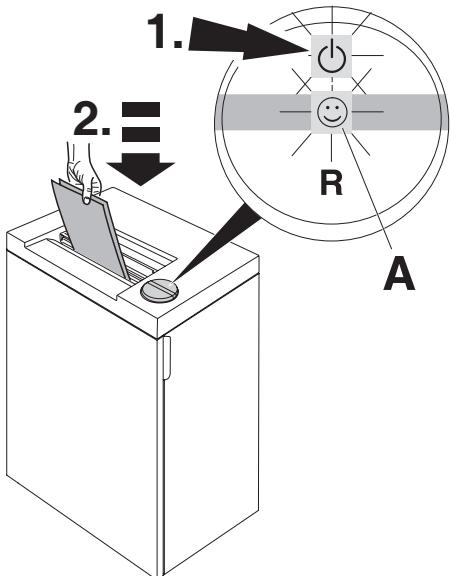
**NL** Schakelaar indrukken (1.) : groen licht gaat aan, machine is bedrijfsklaar. Start automatisch zodra papier wordt ingevoerd (2.). Automatische standby schakelt naar 15 minuten uit.
