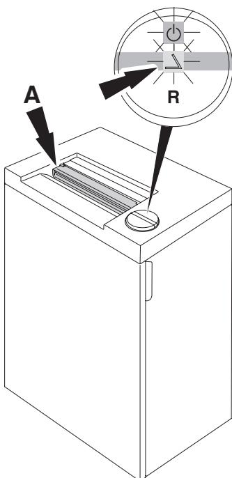
**RU** Аппарат автоматически остановится, если шторка безопасности (**A**) открыта (индикаторы и будут загораться поочередно). Закройте шторку безопасности и нажмите кнопку - аппарат продолжит уничтожать бумагу. Машина может работать некоторое время в реверсном направлении с открытой шторкой безопасности, если Вам необходимо удалить обрезки бумаги или произошло ее замятие.
