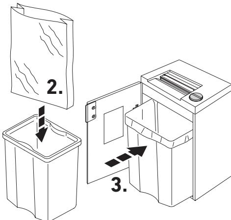
**DE** Tür öffnen, Maschine mit Bedienfeld nach vorne aufsetzen! Auf Finger achten!
