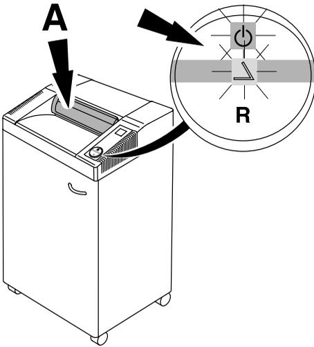
**RUS** Аппарат автоматически остановится, если шторка безопасности (A) открыта (индикаторы  $\Delta$  и  $\text{⏻}$  будут загораться поочередно). Закройте шторку безопасности и нажмите кнопку  $\text{⏻}$  - аппарат продолжит уничтожать бумагу. Машина может работать некоторое время в реверсном направлении с открытой шторкой безопасности, если Вам необходимо удалить обрезки бумаги или произошло её замятие.
