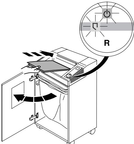
**RUS** При открытии дверцы аппарат останавливается автоматически.
