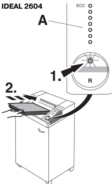
**D** Schalter ⏪ drücken (1.) : grünes Licht leuchtet, Maschine betriebsbereit. Autom. Anlauf bei Papierzufuhr. Autom. stand/by - Abschaltung nach einer Stunde, grüne Kontrollleuchte ⏪ erlischt.
