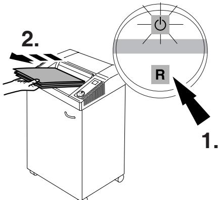
**RUS** Останавливается автоматически при превышении количества уничтожаемой бумаги. Реверс включается автоматически, если произошел затор бумаги.
