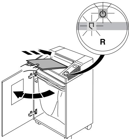
**RUS** При открытии дверцы аппарат останавливается автоматически.
