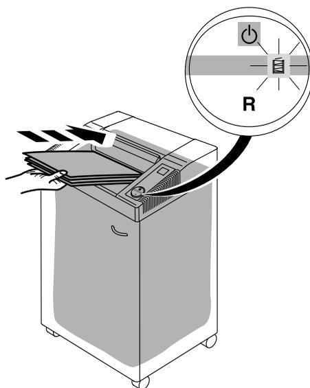
**RUS** При заполнении пластикового мешка аппарат остановится автоматически. Должен загореться индикатор
