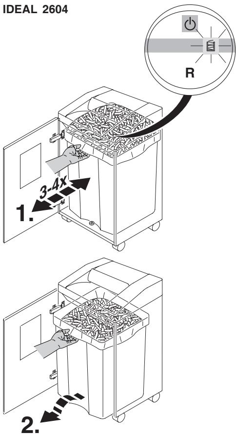
**RUS** При заполнении пластикового мешка аппарат остановится автоматически. Должен загореться индикатор «мешок заполнен» Замените пластиковый мешок. (смотри стр. 9).
