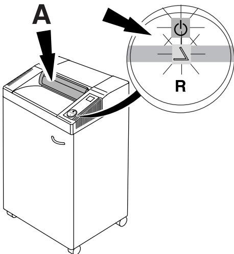
**RUS** Аппарат автоматически остановится, если шторка безопасности (A) открыта (индикаторы  $\Delta$  и  $\odot$  будут загораться поочередно). Закройте шторку безопасности и нажмите кнопку  $\odot$  - аппарат продолжит уничтожать бумагу. Машина может работать некоторое время в реверсном направлении с открытой шторкой безопасности, если Вам необходимо удалить обрезки бумаги или произошло её замятие.
