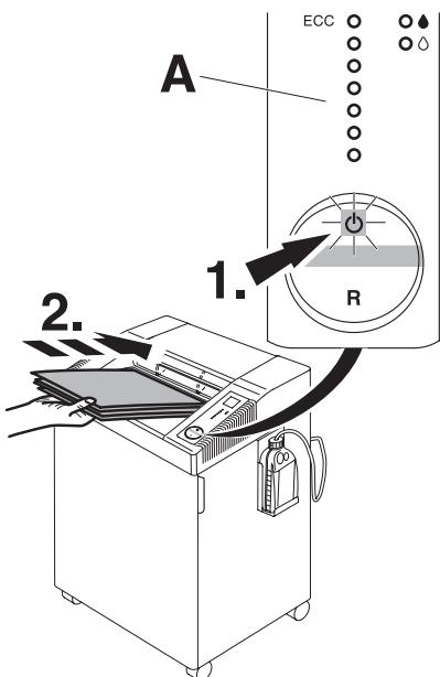
**DE** Schalter drücken (1.) : grünes Licht leuchtet, Maschine betriebsbereit. Autom. Anlauf bei Papierzufuhr (2.). Autom. Standby - Abschaltung nach 30 Minuten. Maschine kann jederzeit durch 2 sec. langes Drücken des Schalters ausgeschaltet werden. Grüne Kontrollleuchte erlischt. Danach verbraucht die Maschine keinen Strom mehr. **Hinweis:** Alle Maschinen haben eine ECC- Anzeige (Electronic Capacity Control) zur Leistungsanzeige beim Vernichten des Papiers (**A**).
