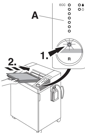
**PT** Pressionar o interruptor de (1.) : a luz verde está ligada, a máquina está agora preparada para funcionar. Inicia automaticamente quando o papel é inserido. O standby automático que desliga depois de 15 minutos. A máquina pode ser desligada a qualquer momento pressionando o interruptor . O indicador LED verde apaga-se.
