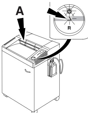
**RUS** Аппарат автоматически остановится, если шторка безопасности (A) открыта (индикаторы  $\Delta$  и  $\odot$  будут загораться поочередно). Закройте шторку безопасности и нажмите кнопку  $\odot$  - аппарат продолжит уничтожать бумагу. Машина может работать некоторое время в реверсном направлении с открытой шторкой безопасности, если Вам необходимо удалить обрезки бумаги, или произошло её замятие. Нажмите кнопку "R" несколько раз, если это необходимо.
