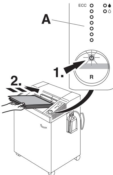
**P** Pressionar o interruptor de (1.) : a luz verde está ligada, a máquina está agora preparada para funcionar. Inicia automaticamente quando o papel é inserido. O standby automático que desliga depois de 30 minutos. A máquina pode ser desligada a qualquer momento pressionando o interruptor durante 2 segundos. O indicador LED verde apaga-se. Não haverá mais consumo de energia.
