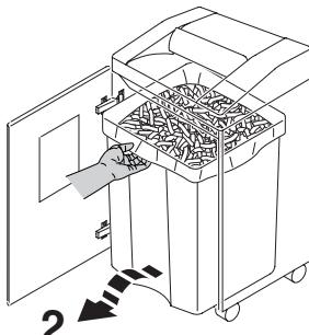
**RUS** При заполнении пластикового мешка аппарат остановится автоматически. Должен загореться индикатор «мешок заполнен» Замените пластиковый мешок. (смотри стр. 12).
