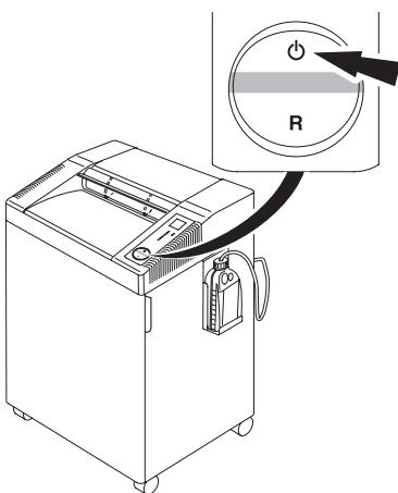
**DE** Autom. Standby - Abschaltung nach 30 Minuten. Maschine kann jederzeit durch 2 sec. langes Drücken des P Schalters ausgeschaltet werden. Grüne Kontrollleuchte R erlischt. Danach verbraucht die Maschine keinen Strom mehr.
