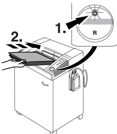
**RUS** Внезапно останавливается измельчитель бумаги, если дверца безопасности (A) открыта (индикаторы  $\Delta$  и  $\odot$  загораются поочередно). Нажмите на кнопку  $\odot$  - измельчитель бумаги продолжит работать.
