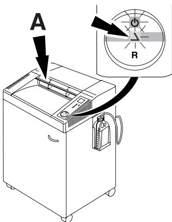
**PL** Automatyczne zatrzymanie jeśli klapka (A) jest otwarta. Zamknąć klapkę i nacisnąć przełącznik  $\Delta$  i  $\circ$ . Aby usunąć resztki papieru powstałe w wyniku zablokowania się papieru, niszczarka pracuje przy otwartej klapce do tyłu przez krótki czas. Jeśli jest taka potrzeba prycisać "R" kilka razy.
