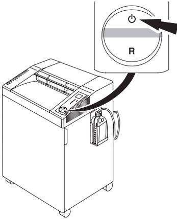
**SV** Automatiskt "standby"-läge som stängs av efter 30 minuter.
