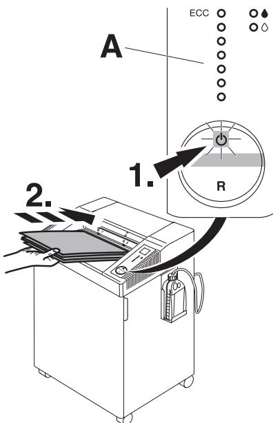
**NL** Schakelaar indrukken (1.) : groen licht gaat aan, machine is bedrijfsklaar. Start automatisch zodra papier wordt ingevoerd (2.). Automatische standby schakelt naar 30 minuten uit. De machine kan op elk gewenst moment worden uitgeschakeld door gedurende 2 seconden op de knop te drukken. Groene LED controlelampje is uit. De machine verbruikt dan geen stroom meer.
