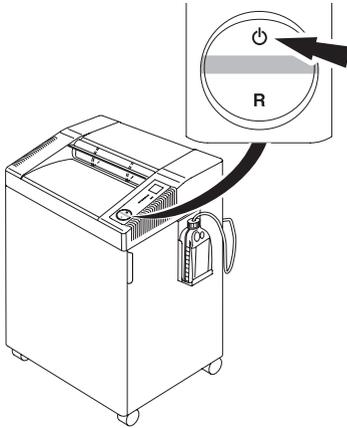
**NL** Automatische standby schakelt naar 30 minuten uit. De machine kan op elk gewenst moment worden uitgeschakeld door gedurende 2 seconden op de ⏻ knop te drukken. Groene LED controlelampje is uit. De machine verbruikt dan geen stroom meer. Binnen deze 30 minuten gebruikt de papiervernietiger de volgende energie:
