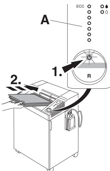
**FI** Paina painiketta. Vihreä merkkivalo ilmoittaa laitteen toimintavalmiuden . Laite käynnistyy automaattisesti paperia syötettäessä. Automaattinen valmiustila, joka kytkeytyy pois 15 min. päästä. Vihreä LED merkkivalo ei pala. Laite voidaan sammuttaa milloin tahansa painamalla painiketta ajan. Vihreä LED merkkivalo ei pala. Virran sammutuksen jälkeen energiankulutusta ei enää ole.
