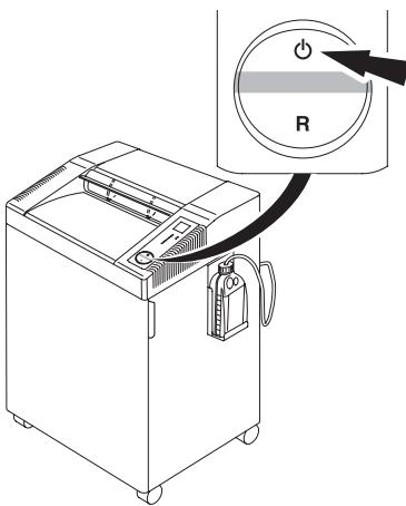
**NL** Automatische standby schakelt naar 30 minuten uit. De machine kan op elk gewenst moment worden uitgeschakeld door gedurende 2 seconden op de  $\odot$  knop te drukken. Groene LED controlelampje is uit. De machine verbruikt dan geen stroom meer. Binnen deze 30 minuten gebruikt de papiervernietiger de volgende energie:
