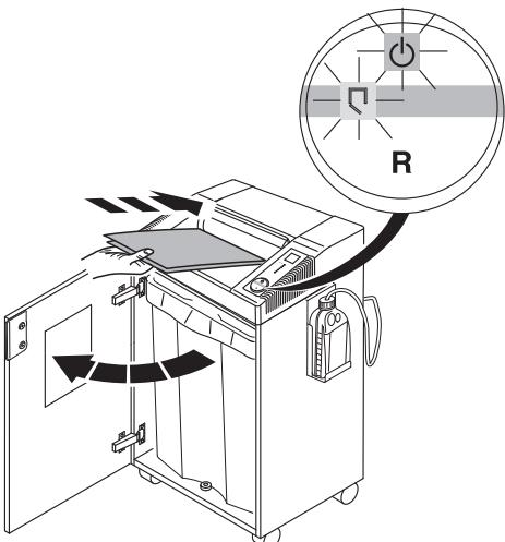
**RU** При открытии дверцы аппарата останавливается автоматически.
