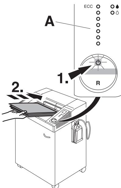
**FIN** Paina painiketta. Vihreä merkkivalo Z ilmoittaa laitteen toimintavalmiuden . Laite käynnistyy automaattisesti paperia syöttääessä. Automaattinen valmiustila, joka kytkeytyy pois 30 min. päästä. Vihreä LED merkkivalo ei pala. Laite voidaan sammuttaa milloin tahansa painamalla painiketta 2 sekunnin ajan.
