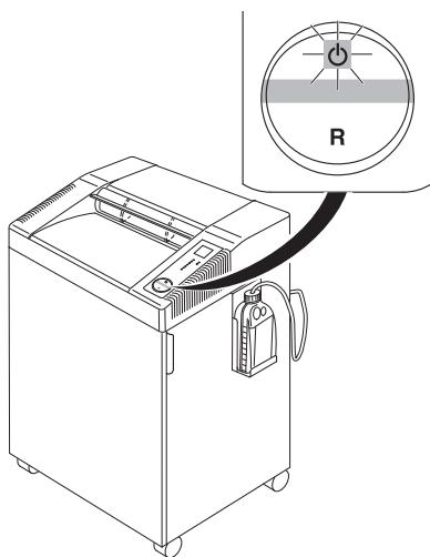
تتوقف الماكينة عن العمل اوتوماتيكيا عند عدم وجود ورق
