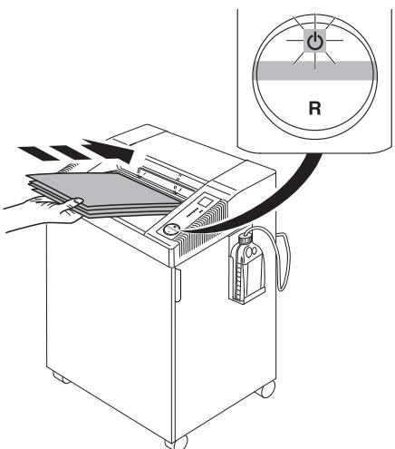
**RU** Останавливается автоматически при превышении количества уничтожаемой бумаги. Реверс включается автоматически, если произошел затор бумаги.
