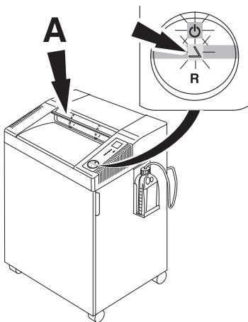
**NL** Automatische stop als de veiligheidsklep (**A**) geopend wordt (Symbolen  $\blacktriangleleft$  en  $\odot$  knipperen afwisselend.)
