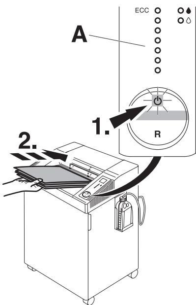
**SV** Tryck på knappen  $\odot$  (1.). Grönt ljus visar "klar att använda", startar automatiskt när papper förs in (2.). Automatiskt "standby"-läge som stängs av efter 30 minuter.
