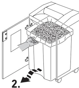
**DE** Automatischer Stopp bei vollem Auffangsack.
