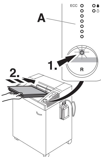
**S** Tryck på knappen (1.). Grönt ljus visar "klar att använda", startar automatiskt när papper förs in. Automatiskt „standby“-läge som stängs av efter 30 minuter.
