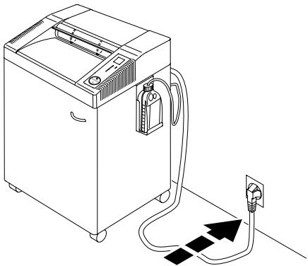
**RUS** Закройте дверцу и подключите вилку электропитания к настенной розетке.
