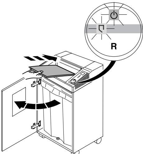
**RUS** При открытии дверцы аппарата останавливается автоматически.
