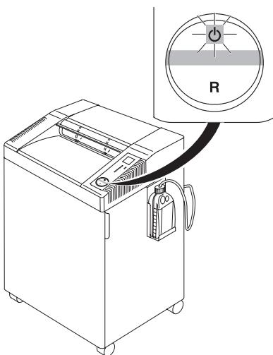
**RU** При отсутствии бумаги аппарат автоматически останавливается.
