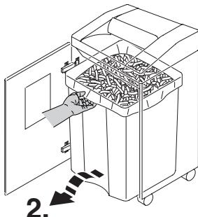
**RUS** При заполнении пластикового мешка аппарат остановится автоматически. Должен загореться индикатор «мешок заполнен» Замените пластиковый мешок. (смотри стр. 9).
