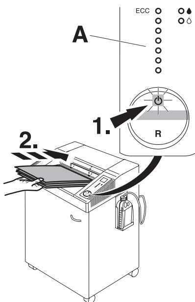
**P** Pressionar o interruptor de  $\odot$  (1.) : a luz verde está ligada, a máquina está agora preparada para funcionar. Inicia automaticamente quando o papel é inserido. O standby automático que desliga depois de 30 minutos. A máquina pode ser desligada a qualquer momento pressionando o interruptor durante 2 segundos. O indicador LED  $\odot$  verde apaga-se. Não haverá mais consumo de energia.
