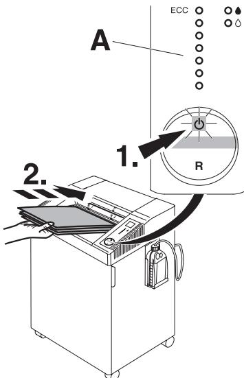
**PT** Pressionar o interruptor de (1.) : a luz verde está ligada, a máquina está agora preparada para funcionar. Inicia automaticamente quando o papel é inserido. O standby automático que desliga depois de 30 minutos. A máquina pode ser desligada a qualquer momento pressionando o interruptor durante 2 segundos. O indicador LED apaga-se. Não haverá mais consumo de energia.
