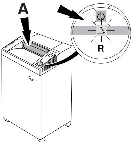
**NL** Automatische stop als de veiligheidsklep (**A**) geopend wordt (Symbolen  $\Delta$  en  $\odot$  knipperen afwisselend.)
