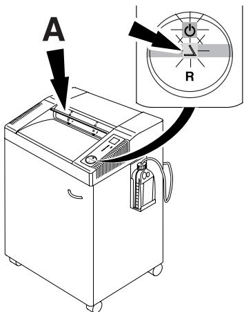
**NL** Automatische stop als de veiligheidsklep (A) geopend wordt (Symbolen  $\Delta$  en  $\circlearrowleft$  knipperen afwisselend.)
