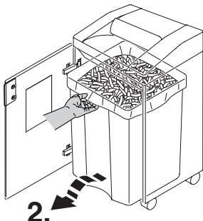
**RU** При заполнении пластикового мешка аппарат остановится автоматически. Должен загореться индикатор "мешок заполнен" Замените пластиковый мешок. (смотри стр. 12).
