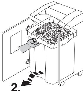
**D** Autom. Stopp bei vollem Auffangsa<sup>c</sup>k.
