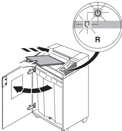
**RU** При открытии дверцы аппарат останавливается автоматически. Индикаторы и будут загораться поочередно.
