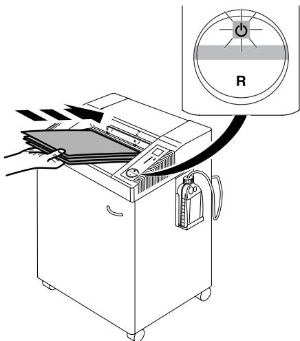
**RUS** Останавливается автоматически при превышении количества уничтожаемой бумаги. Реверс включается автоматически, если произошел затор бумаги.
