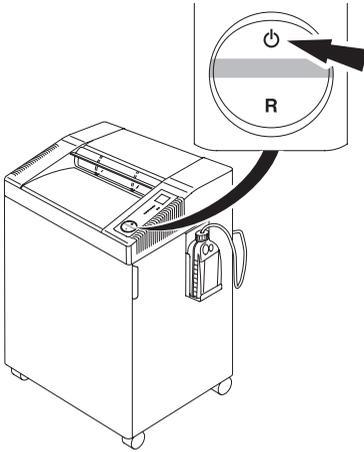
**NL** Automatische standby schakelt naar 30 minuten uit. De machine kan op elk gewenst moment worden uitgeschakeld door gedurende 2 seconden op de
