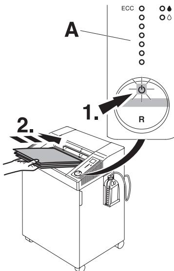
**FI** Paina painiketta. Vihreä merkkivalo ilmoittaa laitteen toimintavalmiuden. Laite käynnistyy automaattisesti paperia syötettäessä. Automaattinen valmistiila, joka kytkeytyy pois 30 min. päästä.
