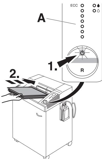
**D** Schalter drücken (1.) : grünes Licht leuchtet, Maschine betriebsbereit. Autom. Anlauf bei Papierzufuhr. Autom. stand/by - Abschaltung nach 30 Minuten. Maschine kann jederzeit durch 2 sec. langes Drücken des Schalters ausgeschaltet werden. Grüne Kontrolleuchte erlischt. Danach verbraucht die Maschine keinen Strom mehr. Hinweis: Alle Maschinen haben eine ECC- Anzeige (Electronic Capacity Control) zur Leistungsanzeige beim Vernichten des Papiers (**A**).
