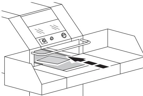
**RU** Если аппарат работает неправильно (направление движения конвейерной ленты изменено), то обратитесь к электрику для проверки подключения фаз электропитания.
