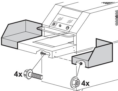
**DE** Seitentische an der Maschine befestigen.
