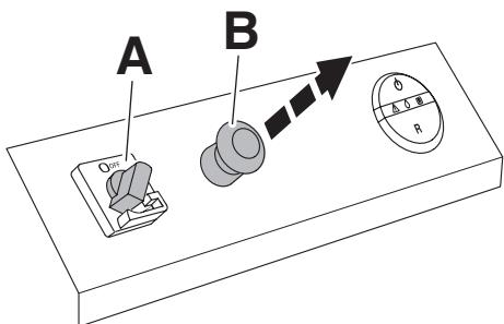
**RU** Главный выключатель (**A**) в положении «I on»? Аварийный выключатель (**B**) отжат?
