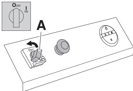
**RU** Если аппарат не используется долгое время, отключите его. Поверните главный выключатель (**A**) в положение «0 OFF».
