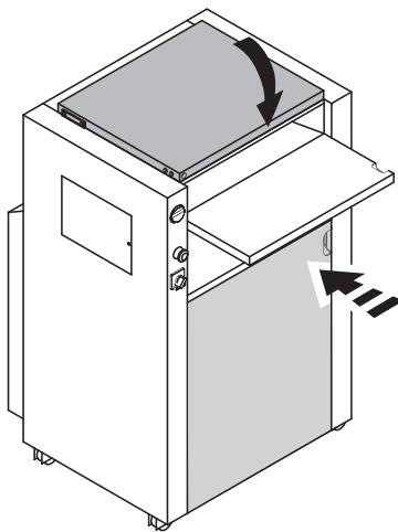
**RU** Машина работает только при закрытых дверце крышка.
