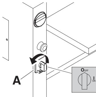
**RU** Если аппарат не используется долгое время, отключите его. Поверните главный выключатель (**A**) в положение «**0 OFF**».
