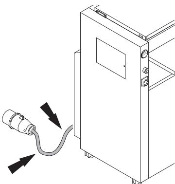
**RU** Предохраняйте основной кабель от перегрева, попадания масла и острых кромок!
