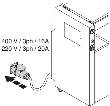
تأمين قابس التيار الكهربائي بالشكل المطلوب .
