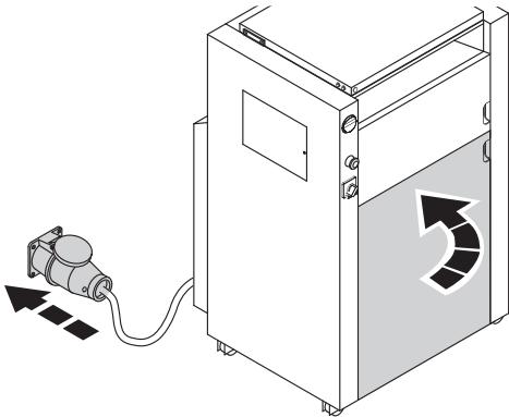
أغلق الباب وضع المقبس في مصدر التيار الكهربائي
