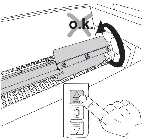
**DE** Dreht die Flügelwelle in die falsche Richtung → Drehfeld von einer Elektrofachkraft ändern lassen.
