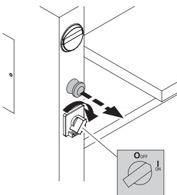
**RU** Главный выключатель (A) в положении «I on»? Аварийный выключатель (B) отжат?
