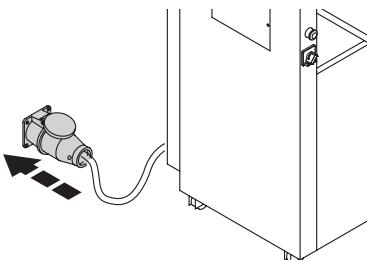
**RU** Проверьте, подключена ли машина к электрической сети?
