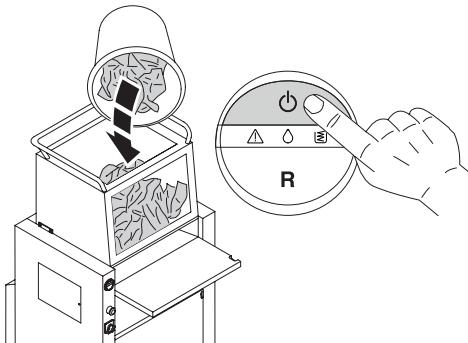
**RU** При загрузке бумаги сверху, машина включается/выключается вручную.
