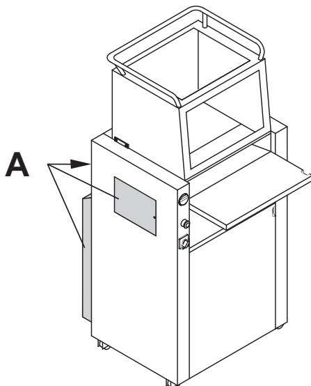
**RU** Все компоненты, которые могут представлять опасность для оператора, закрыты защитными крышками и снабжены дверцами (**A**).
