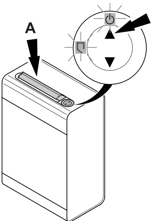
**D** Autom. Stopp wenn Sicherheitsklappe (**A**) geöffnet wird (Symbol  $\square$  blinkt).
