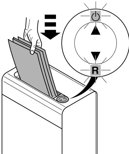
**RUS Машина остановилась. Сработал автомат перегрузки. Не включайте машину 10-15 минут.** (Символ  $\odot$  и «R» мерцают попеременно).
