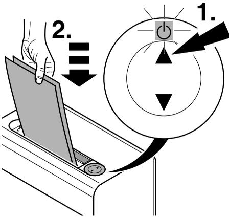
**RUS** Нажмите кнопку ▲ (⏻), загорится зеленый светодиод ⏻, машина снова готова к работе. Если установить бумагу в приемный слот, машина автоматически начнет работать. Режим ожидания выключается через час. Зелёный светодиод ⏻ не горит.
