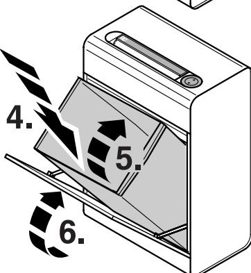
**D** Autom. Stopp bei vollem Auffangbehälter. Anzeige Symbol "Auffangbehälter - voll" leuchtet gelb. Auffangbehälter entleeren.
