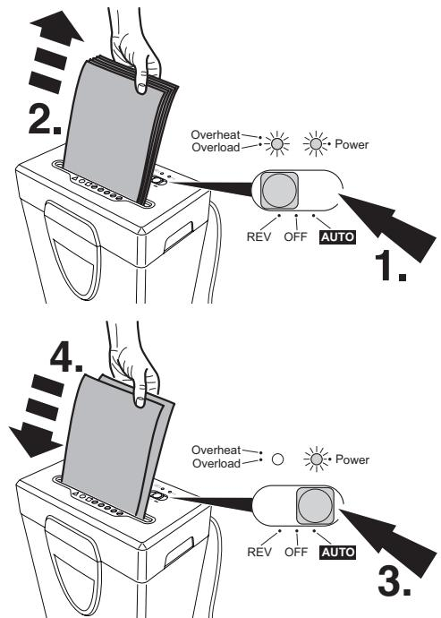
**E** El equipo se para automáticamente si se alimenta demasiado papel (si la maquina está bloqueada, la LED amarilla indica sobrecarga)
