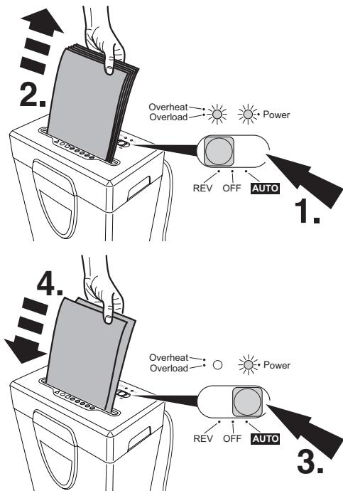
**RUS** Шредер останавливается автоматически, если вставлено слишком много бумаги (машина блокируется, загорается жёлтый LED Overload). Переведите выключатель в положение "**REV**" (1.). Шредер движется назад, и можно извлечь бумагу (2.). Переведите выключатель в положение "**AUTO**" (3.). Затем вставьте меньшее количество бумаги (4.). Максимальное количество бумаги:
