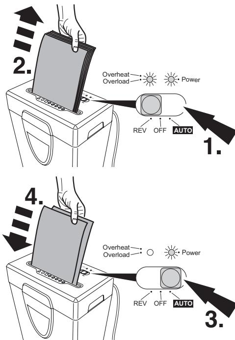
**DE** Automatischer Stopp bei zu viel Papier, Maschine blockiert, (gelbe LED Overload leuchtet nur bei SHREDCAT 8240). Schalter auf "REV" schieben (1.), Maschine läuft rückwärts, Papier entnehmen (2.). Schalter wieder auf "AUTO" schieben (3.), weniger Papier zuführen (4.). Maximale Blattzahl:
