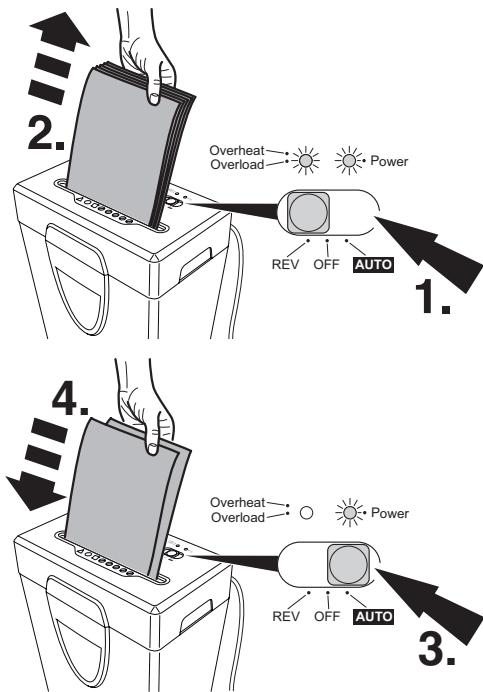
**D** Automatischer Stopp bei zu viel Papier. (Maschine blockiert), gelbe LED Overload leuchtet). Schalter auf "REV" schieben (1.), Maschine läuft rückwärts, Papier entnehmen (2.). Schalter wieder auf "AUTO" schieben (3.), weniger Papier zuführen (4.). Maximale Blattzahl:
