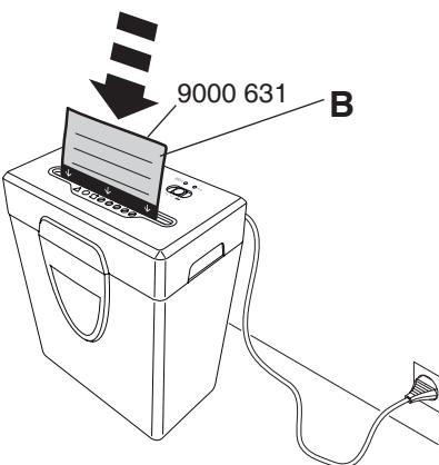
**DE** Bei nachlassender Schneidleistung oder nach jedem gefüllten Auffangbehälter Schneidwerk ölen! (siehe Bild)
