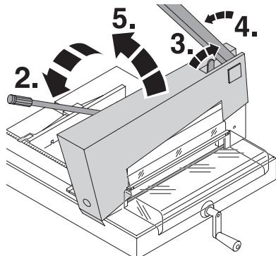
**DE** Der Messerhebel (A) darf nicht selbstständig nach unten fallen. Gegebenenfalls Sechskantmutter nachziehen. Abdeckhaube (K) entfernen: Die 2 Schrauben (P) der Abdeckhaube herausdrehen (1.). Pressung schließen (2.). Messerarretierung lösen (3.). Messerhebel etwas nach links stellen (4.), dann Abdeckhaube (5.) abnehmen.
