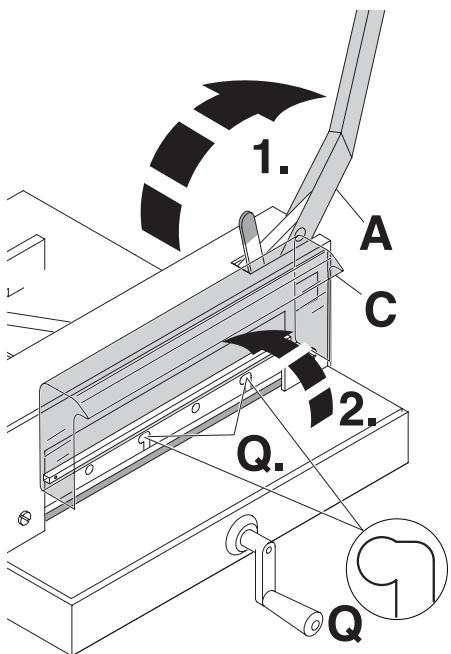
**DE Messerwechsel von der Vorderseite der Maschine vornehmen:**
