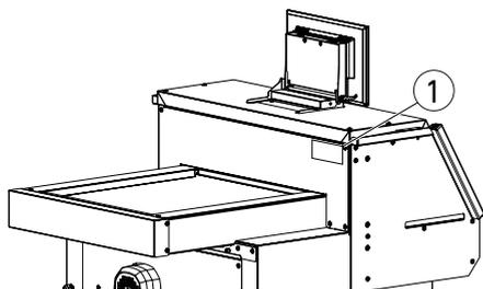
Los datos técnicos específicos se encuentran indicados en la placa de características ① de la máquina. Para reclamar una prestación de la garantía, el aparato debe poder identificarse mediante la placa de características.
