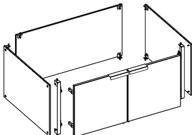
Revestimiento del bastidor inferior
