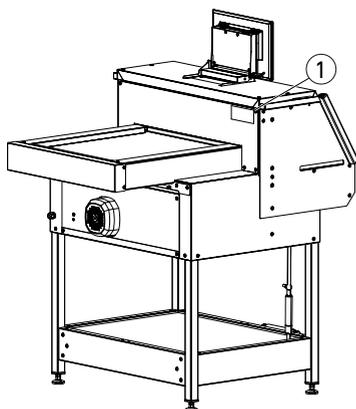
Die spezifischen technischen Daten entnehmen Sie bitte den Angaben auf dem Typenschild ① der Maschine. Für die Inanspruchnahme einer Garantieleistung muss das Gerät durch das Typenschild zu identifizieren sein.
