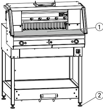
Mit den 4 Stellfüßen ② wird die Maschine ausgerichtet und kann in der Höhe verstellt werden:
