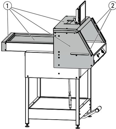
Gefahrbringende Maschinenteile sind durch Schutzeinrichtungen abgesichert und durch Verkleidungen ① abgedeckt. Die Maschine darf nur mit allen Sicherheits- und Verkleidungsteilen betrieben werden, insbesondere:
