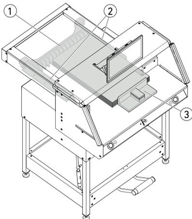
Papieranlage am Rückanschlag ① und Seitenanschlag links oder rechts ②. Zum Verschieben von Papierstapeln, den mitgelieferten Stapelwinkel ③ benutzen. Zum Drehen des Papierstapels erst Rückanschlag nach vorne fahren.
