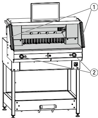
Травмоопасные режущие движения блокируются защитным световым барьером ① и двуручным включением резания ②!
