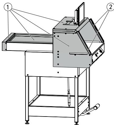
Опасные части машины ограждены защитными приспособлениями и закрыты деталями корпуса ①. Эксплуатация машины допускается только со всеми установленными защитными приспособлениями и деталями корпуса, в частности, с такими как:
