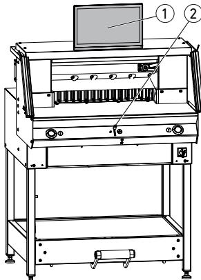
Регулировка размера осуществляется вручную с помощью элемента управления электрической регулировкой заднего упора (2) или путем программирования размера резания на сенсорный дисплей Multi-Touch (1).
