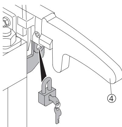
**DE** Bei allen Maschinentypen darf der Messerschutz ① nicht abgenommen werden und muß jederzeit funktionsfähig sein. Die Modelle IDEAL 1080, und IDEAL 1110 sind mit einer Messerverschlußvorrichtung ausgestattet. Bei Bedarf kann der Messerhebel ④ mit dem mitgelieferten Schloß gesichert werden, um Mißbrauch zu verhindern.
