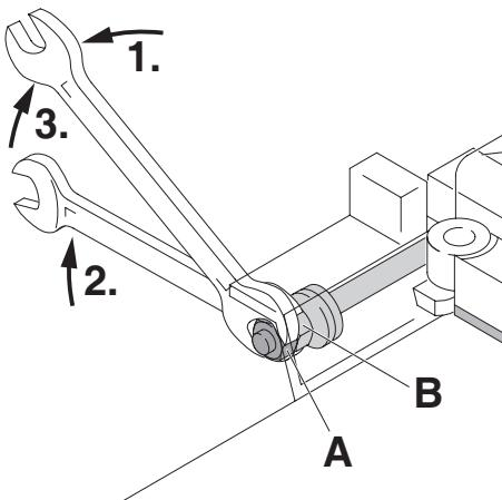
**DE** Die Maschine ist mit einer **Friktionseinrichtung** am Messerhebel ausgerüstet. Sie verhindert, daß der Messerhebel sich aus einer angehobenen Stellung selbstständig nach unten bewegt. Ist dies dennoch der Fall, so muß die Friktionseinrichtung wie folgt nachjustiert werden:
