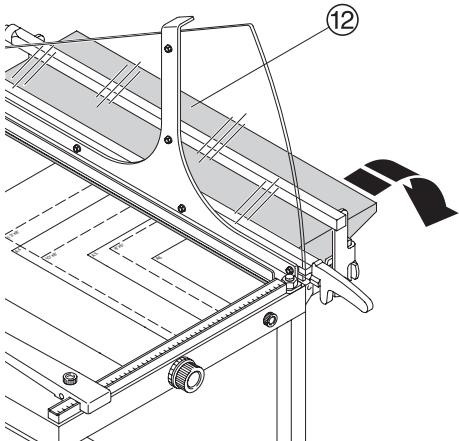
**IT** La carta può essere posizionata anche a filo con la battuta anteriore dotata di dispositivo per rifili millimetrici ⑧. La manopola graduata ⑪ consente di determinare con precisione la misura di taglio desiderata, può essere fissata tramite la vite di regolazione per eseguire tagli multipli. I rifili millimetrici (meno di 10 mm) sono possibili grazie allo spostamento automatico della squadra di battuta anteriore durante il taglio.
