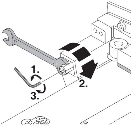
A máquina têm um **aparelho de fricção** suporte da faca não consegue movimentar para baixo por si. Ao fazer este movimento reajustar o aparelho de fricção da seguinte maneira:
