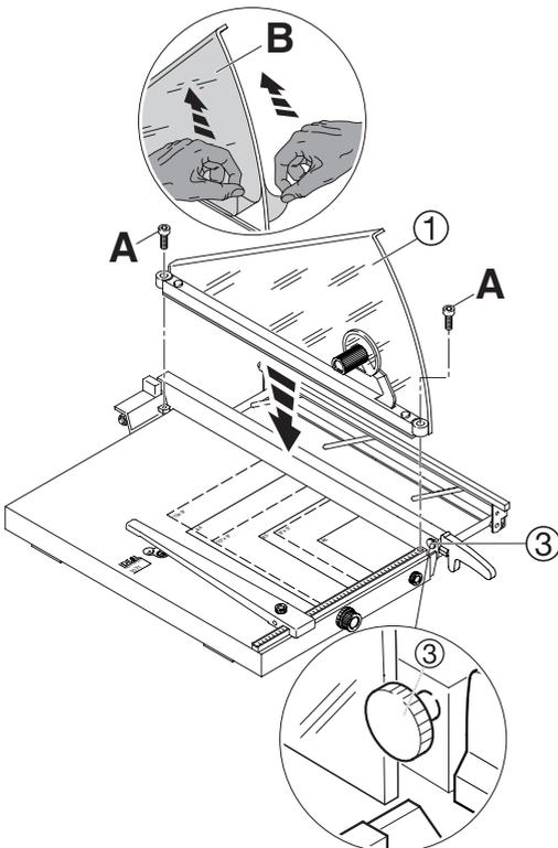
O dispositivo de calcar, com o protector da lâmina ① deve ser montado na cisalha antes de operar. Para realizar isto deve colocar o protector da faca na mesa da cisalha. O protector da lâmina ① deve estar fixo perto da guia ③. Depois, segurar e apertar com os 2 parafusos (A) de wrench screws cabeça incluídos enclosed hex head wrench screws. (ver imagem).
