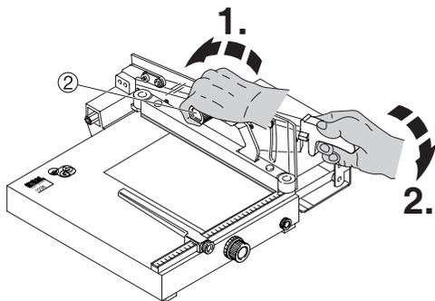
Depois calcar o papel com o calcador manual ② ou com o pela de pé ⑬ (Só os modelos IDEAL 1080, IDEAL 1110) e efectuar o corte.
