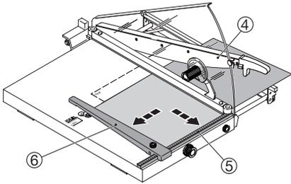
Levantar o suporte da faca ④ e inserir o papel desde do lado esquerdo. O esquadro traseiro ⑥ e o batente lateral ⑤ que permite o papel a ser posicionada correctamente.
