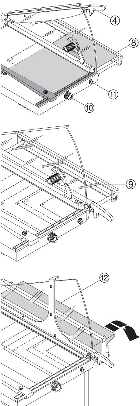
**RU** Размеры реза можно задавать, используя передний упор с устройством для отрезания узких полос ⑧. Нужный размер для повторных резов можно точно задать калибровочной ручкой ⑩ и зафиксировать положение стопорной ручкой ⑪. Узкий рез (менее 10 мм) возможен благодаря тому, что передний упор во время реза автоматически уходит в сторону. **При отрезании узких полос, чтобы точно выдерживать размер, ножодержатель ④ должен находиться в верхнем положении.**
