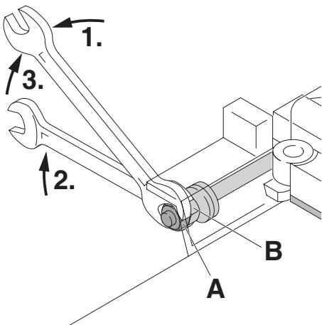
**PL** Urządzenie posiada mechanizm utrzymujący odpowiednią siłę tarcia, co zapobiega samoczynnemu opadaniu noża. Jeśli jednak nóż opada samoczynnie, należy wyregulować siłę tarcia zgodnie z poniższymi instrukcjami.
