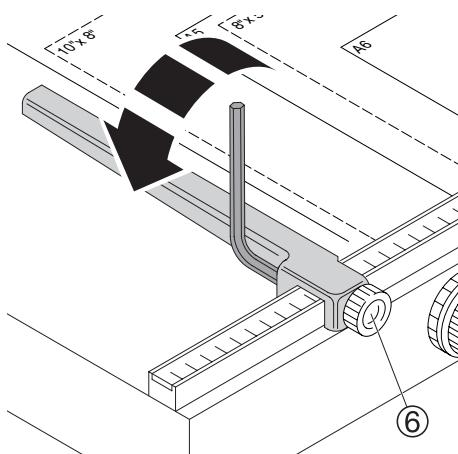
**RU IDEAL 1038, 1058:** При необходимости с помощью ключа шестигранника (2 мм) можно стопорным винтом ⑥ отрегулировать угол заднего упора.
