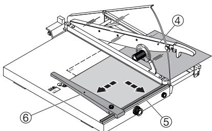
**RU** Поднимите ножодержатель (4) и положите бумагу слева. Задний упор (6) и боковой упор (5) обеспечивают точное позиционирование бумаги.
