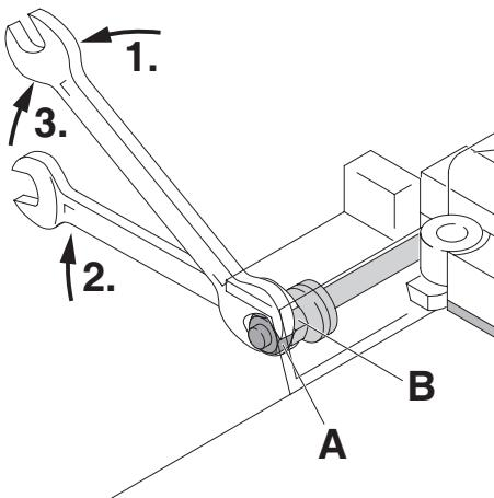
**RU** В резаке на ножедержателе имеется фрикцион. Он гарантирует, что ножедержатель не будет самопроизвольно опускаться. Если, всё же, такое происходит, заново отрегулируйте фрикцион следующим образом:
