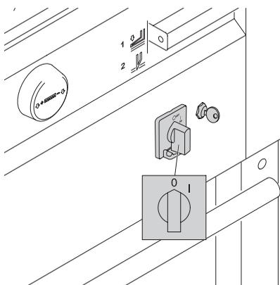
Messer- und Schnittleistenwechsel nur bei abgeschaltetem Hauptschalter!
