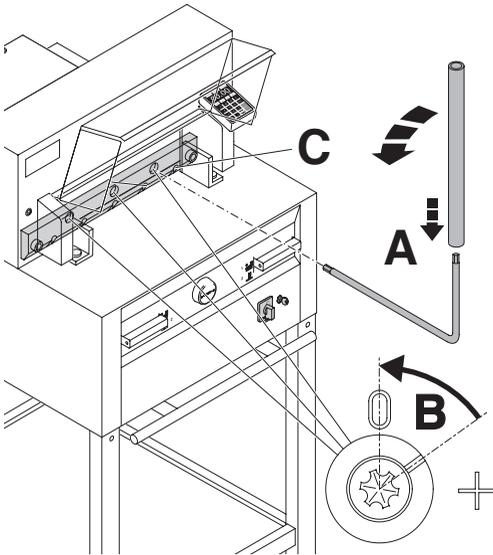
Die nun sichtbaren 3 Exzenter mit Spezialschlüssel und aufgestecktem Verlängerungsrohr (A) gegen Uhrzeigersinn zurückdrehen, Kerbe muß mit der Position "0" übereinstimmen (B).
