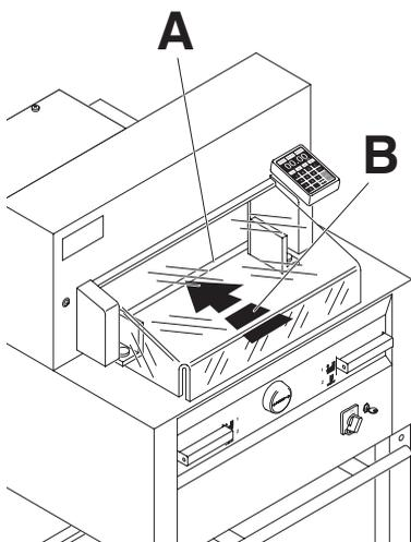
Schnittanzeige durch optischen Lichtstrahl (A) (Messer schneidet an der vorderen Kante (B) des Lichtstrahls, nur verwenden wenn kein genaues Maß geschnitten werden soll).
