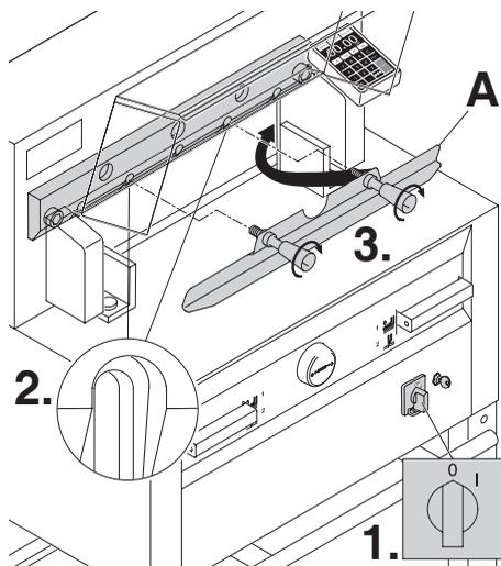
Hauptschalter auf Position "0" stellen. (1.) Die beiden Messerschrauben an den Langlöchern herausdrehen (2.), Messerwechsellvorrichtung (A) ansetzen und fest verschrauben (3.).
