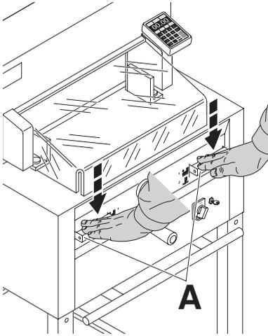
Die für Personen gefährbringende Schneidbewegung ist durch eine schwenkbare Haube vorne (A) und eine Zweihandauslösung (B) abgesichert!
