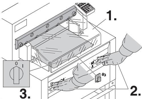
Haube vorne schließen (1.). Messer durch Schnittausrösung nach unten fahren (2.) und einen der beiden Betätiger festhalten dann Hauptschalter auf "0" stellen (3.).
