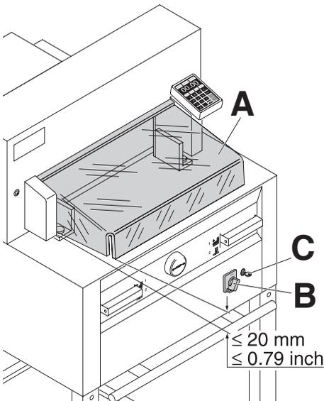
Vor jedem Arbeiten und nach jedem Messerwechsel, Abschaltfunktion von Haube vorne (A), (ist korrekt wenn Spalt zwischen Tisch und Haube vorne  $< 20 \text{ mm}$  beträgt) Hauptschalter (B) und Steuerung (C) überprüfen!
