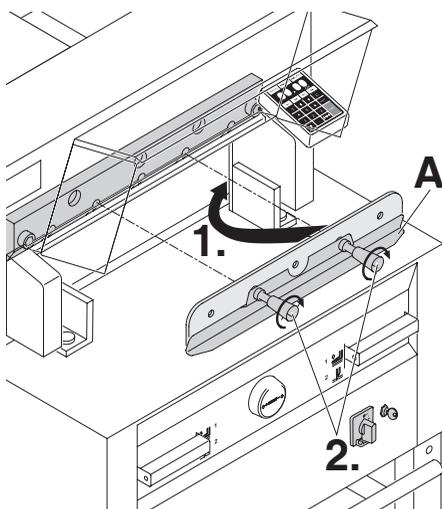
Austauschmesser mit aufgeschraubter Messerwechseleinheit (A) ganz nach oben in den Messerträger schieben (1.) und dort Griffe festdrehen (2.).
