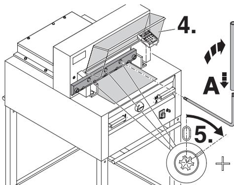
Haube vorne öffnen (4.). Mit dem Spezialschlüssel (A) die 3 Exzenter so weit nach unten drehen, bis das gesamte Papier durchgeschnitten ist (5.). (Messer darf dabei parallel nicht zu tief in die Schnittleiste eindringen).
