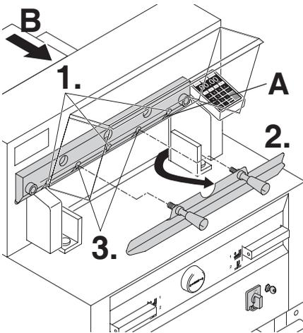
3 bzw. 2 (bei IDEAL 4855) der 5 Messerschrauben mit den Unterlagscheiben leicht festschrauben (1.), Messerwechsellvorrichtung entfernen (2.), restliche 2 Messerschrauben mit Unterlagscheiben leicht festschrauben (3.). Messerwechsellvorrichtung in Werkzeughalter (B) zurück hängen.
