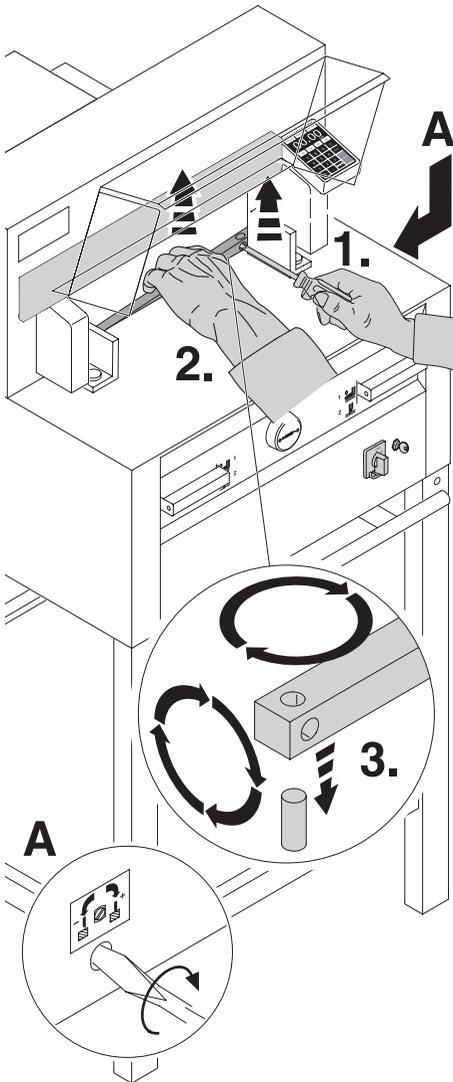
Schnittleiste mit einem kleinen Schraubendreher herausnehmen. Schnittleiste drehen, wenden oder bei Bedarf austauschen.
