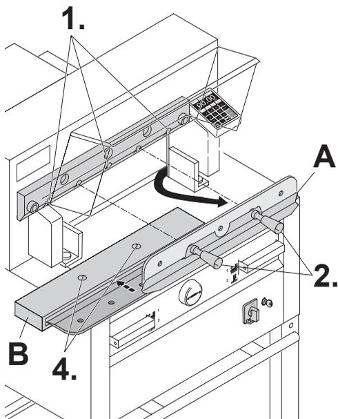
Die restlichen 2 Messerschrauben IDEAL 4855 bzw. 3 Messerschrauben IDEAL 5255, IDEAL 6655 herausdrehen (1.) und die Griffe der Messerwechsellvorrichtung (A) vorsichtig etwas lockern (2.). Das Messer nach unten entnehmen (3.). Messer in den dafür vorgesehenen Messerkasten (B) legen und festschrauben (4.).
