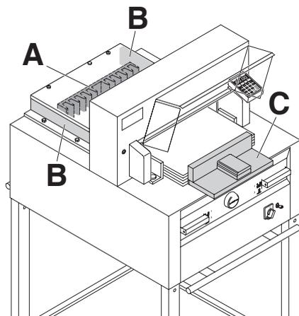
Papieranlage am Rückanschlag (A) und Seitenanschlag links oder rechts (B). Zum Verschieben von Papierstapeln, den mitgelieferten Stapelwinkel (C) benutzen. (Zum Drehen des Papierstapels erst Rückanschlag nach vorne fahren).
