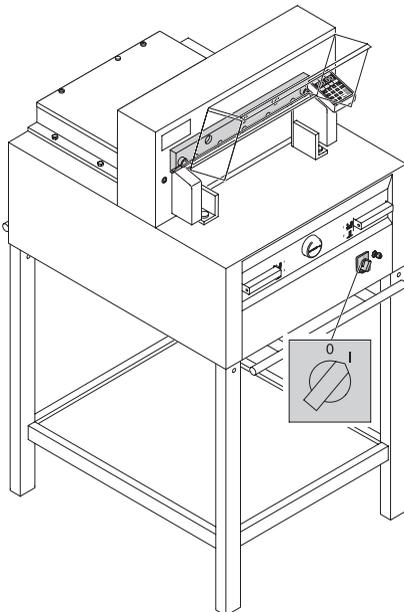
Den Spezialschlüssel entfernen.
