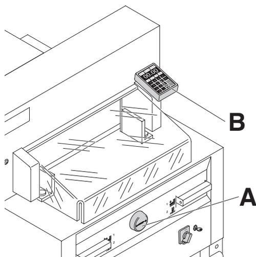
La escuadra trasera se puede programar manualmente mediante el mando giratorio electrónico (A) o bien a través del módulo de control programable (B) con lectura digital de medidas en cm o pulgadas.
