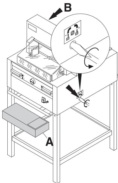
Girar el tornillo de ajuste de la cuchilla hacia la izquierda hasta el final (Destornillador en el set de herramientas (A) o set de herramientas (B)).
