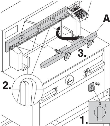
Poner el interruptor principal en posición "0" (1.). Sacar los dos tornillos de la cuchilla de los agujeros oblongos (2.). Colocar el dispositivo de cambio de cuchilla (A) y atornillarlo con fuerza (3.).
