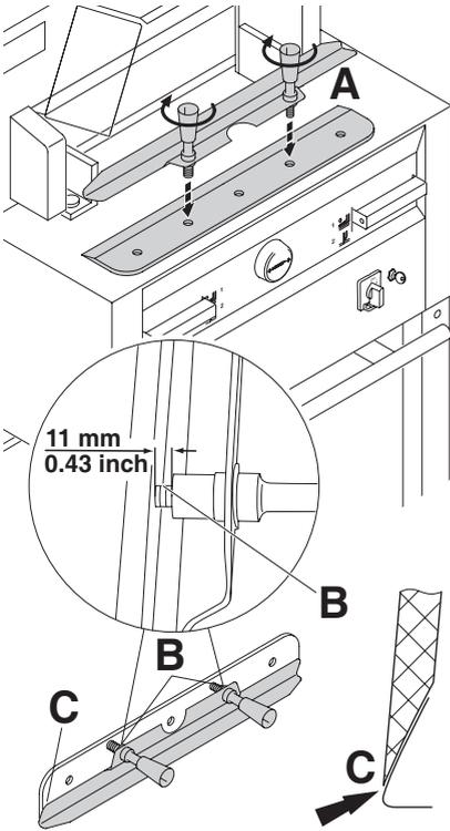
Para sacar la cuchilla de recambio de la caja, cogerla con cuidado y atornillarla con el dispositivo de cambio de cuchilla (A.).
