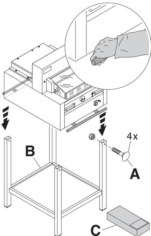
Bajar la máquina entre 4 personas fuertes del palet y colocarla encima de la mesa. Asegurar con 4 tornillos de sujeción (A). Introducir la bandeja (B) en la mesa. (Las piezas de montaje y herramientas están en el set de herramientas (C)).
