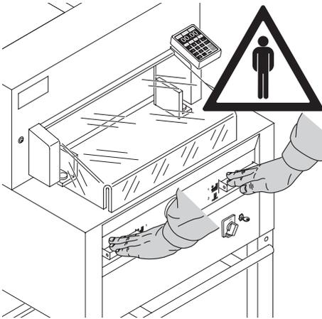
La máquina está concebida para recortar pilas de hojas de papel a determinadas medidas. ¡Esta máquina esta diseñada para el uso de una sola persona!
