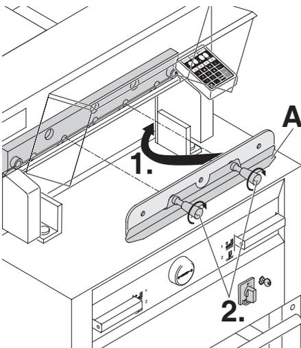
Colocar la cuchilla de recambio junto con el dispositivo (A) en el portacuchillas (1.) hasta arriba del todo y apretar los mangos (2.).
