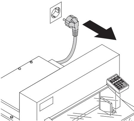
¡Antes de levantar la tapa o realizar cualquier tipo de mantenimiento, desconectar el enchufe principal!
