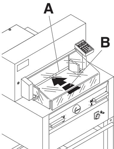
La línea óptica (A) indica donde se efectuará el corte. La cuchilla corta en el borde delantero de la línea (B). (usar solamente si no es necesario un corte exacto).
