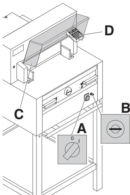
Posición del interruptor principal en "I" (A). Insertar la llave de control del sistema y girarla hacia la derecha (B). Abrir la tapa de seguridad (C). Ahora la máquina está preparada para trabajar.
