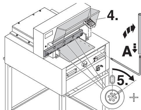
Abrir la tapa de seguridad (4.) con la llave especial (A) y aflojar las 3 excéntricas hacia abajo (5.) hasta que el papel se haya cortado en su totalidad (la cuchilla en posición paralela no ha de entrar con demasiada profundidad en el cuadradillo).
