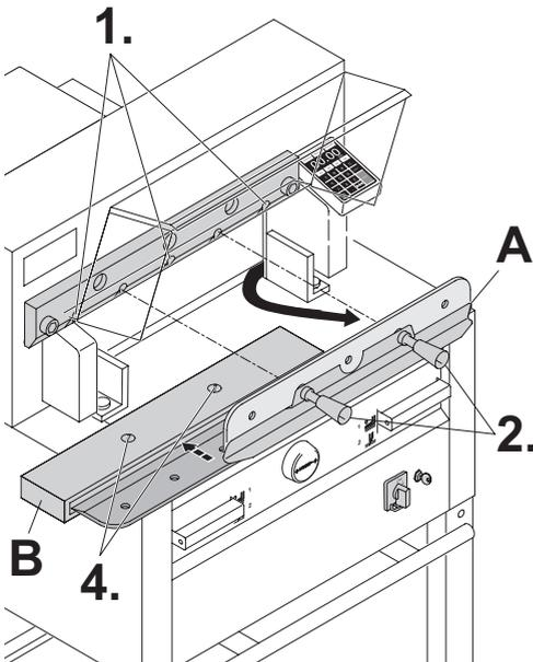
Retirar los 2 restantes tornillos de la cuchilla 4855, y/o 3 tornillos de la cuchilla 5255, 6655 (1.). Aflojar ligeramente los mangos (2.) del dispositivo de cambio de cuchilla (A). Sacar la cuchilla desde abajo (3.). Colocar la cuchilla en la caja (B) prevista para ello y atornillarla (4.).
