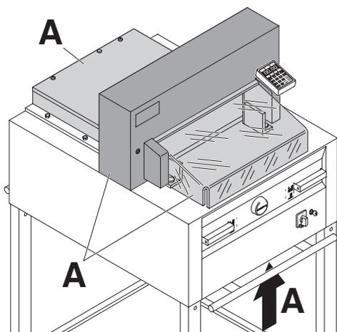
Las partes peligrosas de la máquina están protegidas por una tapa de seguridad (A).
