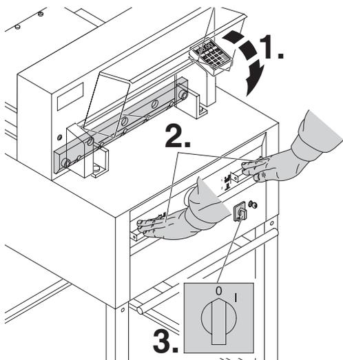
Cerrar la tapa de seguridad (1.). Bajar la cuchilla pulsando ambos elementos de corte (2.). Mantener un elemento de mando y apagar el interruptor principal (3.).
