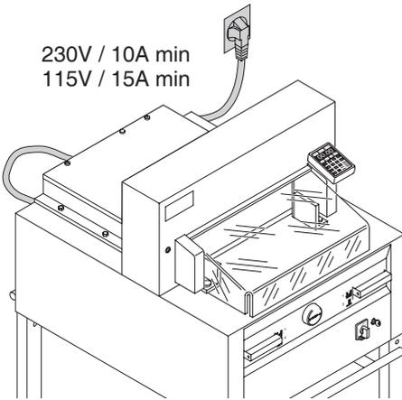
Conectar el cable eléctrico a un interruptor monofásico
