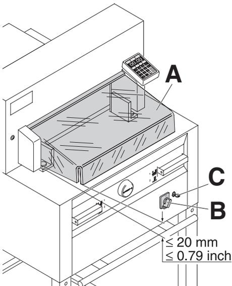
Antes de utilizar la máquina y después de cada cambio de cuchilla hay que revisar la función de paro automático de la tapa de seguridad (A) (correcta si la distancia entre la tapa de seguridad y la mesa es  $< 20\text{mm.}$ ), interruptor principal (B) y panel de control (C).
