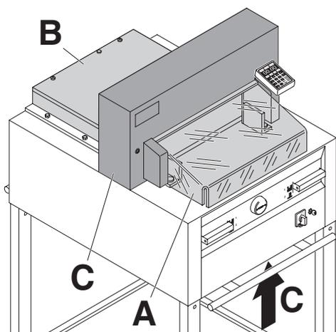
Prohibido el accionamiento de la máquina sin los dispositivos de seguridad (tapa delantera móvil (A), tapa trasera inmóvil (B) y revestimientos (C)).
