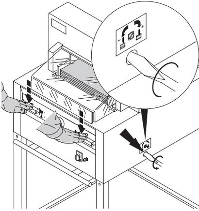
Para comprobar el buen funcionamiento de corte cortar una pila de papel. Si no se ha cortado la última hoja y/o varias hojas, girar el tornillo de ajuste de la cuchilla (A) progresivamente hacia la derecha en una cuarta parte hasta que todas las hojas se hayan cortado en su totalidad. (No colocar la cuchilla muy bajo, desgaste de la misma).
