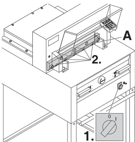
Poner el interruptor principal en posición "I" (1.), la cuchilla se desplazará hacia arriba. Atornillar con fuerte los 5 tornillos de la cuchilla (2.).
