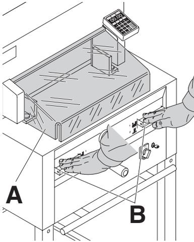
La acción de corte que puede resultar peligrosa para el usuario está protegida por una tapa de seguridad móvil (hacia arriba y hacia abajo) (A) y un sistema de control bimanual (B).
