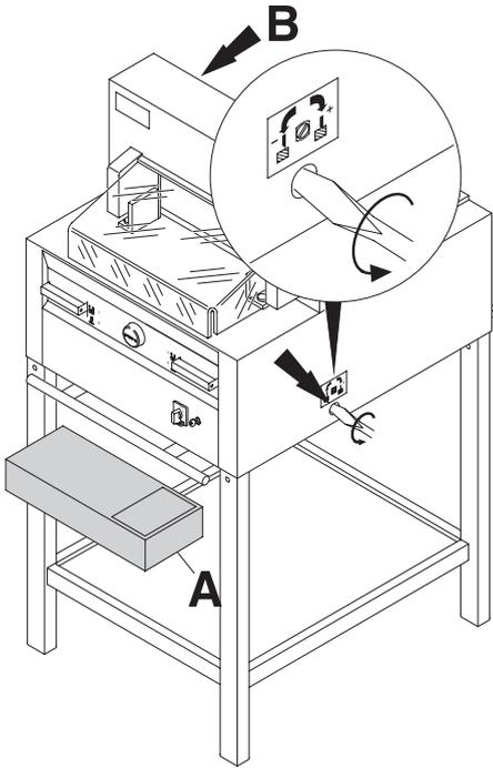
Desserrer (tourner vers la gauche) jusqu'à être en butée, la vis de réglage de la lame (tournevis dans trousse à outils (A) ou dans le porte-outils (B))
