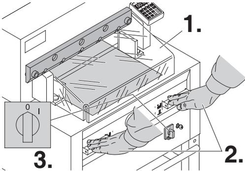
Refermer le carter avant (1.) Amener la lame en position basse (2.) et l'immobiliser dans cette position en maintenant appuyé un des deux boutons de la commande bi-manuelle, et en basculant l'interrupteur principal sur "0" (3.).
