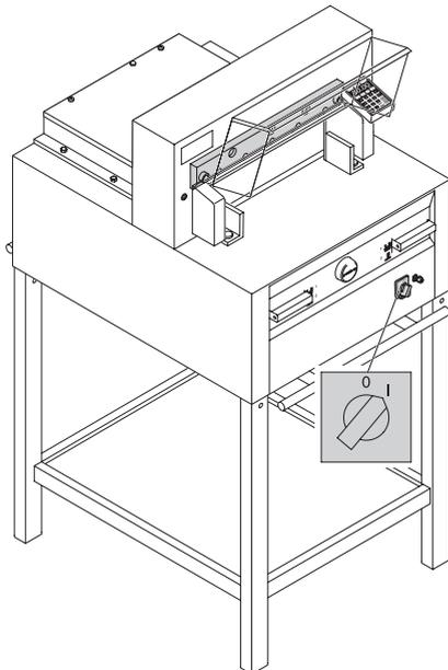
Enlever la clé spéciale. Refermer le carter avant. Basculer l'interrupteur principal sur "I" et attendre que la lame soit complètement remontée.
