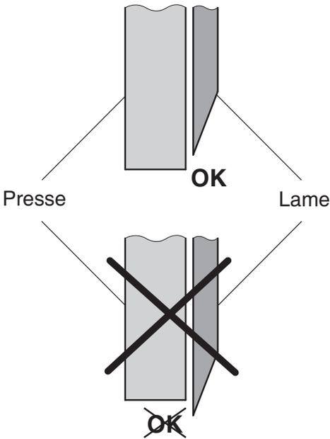
**⚠ Danger! La lame doit toujours être recouverte par la presse**
