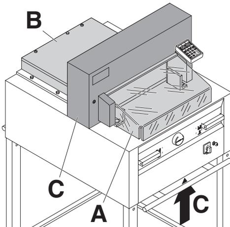
Utiliser le massicot sans ses dispositifs de sécurité - carter de protection avant (A), carter de protection arrière fixe (B) et panneau de protection (C) - est strictement interdit !
