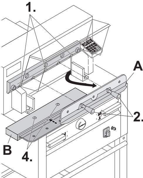
Enlever les 2 ou 3 vis de lame (1.) restantes (2 vis sur 4855; 3 vis pour 5255 et 6655).
