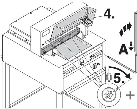
Rouvrir le carter avant (4.). A l'aide de la clé spéciale, tourner les 3 cames vers le bas (5.) jusqu'à ce que le papier soit coupé sur toute sa longueur (la lame doit se positionner parallèlement à la réglette, mais ne doit pas s'enfoncer trop dans celle-ci).
