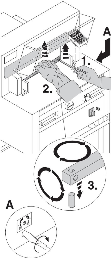
Dégager la réglette avec un petit tournevis. Tourner la réglette ou bien la remplacer si nécessaire (la réglette peut être utilisée 8 fois).
