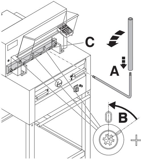
Tourner les 3 cames maintenant visibles à l'aide de la clé spéciale et du tube de prolongement (A) (outils dans la trousse à outillage), dans le sens contraire des aiguilles d'une montre. L'encoche doit s'aligner sur la position "0"(B).
