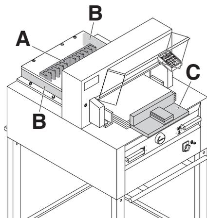
Positionner le papier contre la butée arrière (**A**) et la butée latérale droite ou gauche (**B**). Pour déplacer la pile de papier, utiliser la cale de taquage (**C**) fournie (pour tourner la pile de papier, déplacer d'abord la butée arrière vers l'avant).
