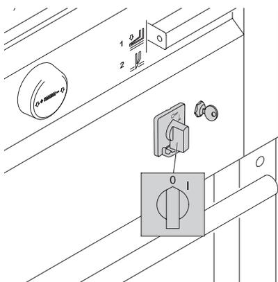
Le remplacement de la réglette ou de la lame ne peuvent se faire que lorsque l'interrupteur principal est en position d'arrêt !
