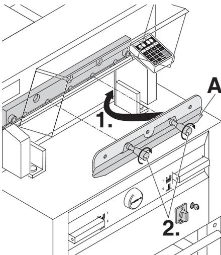
Introduire la lame neuve avec le dispositif de changement de lame (A) dans le porte lame (le plus haut possible) (1.). Serrer les poignées pour bloquer la lame sur le porte-lame (2.).
