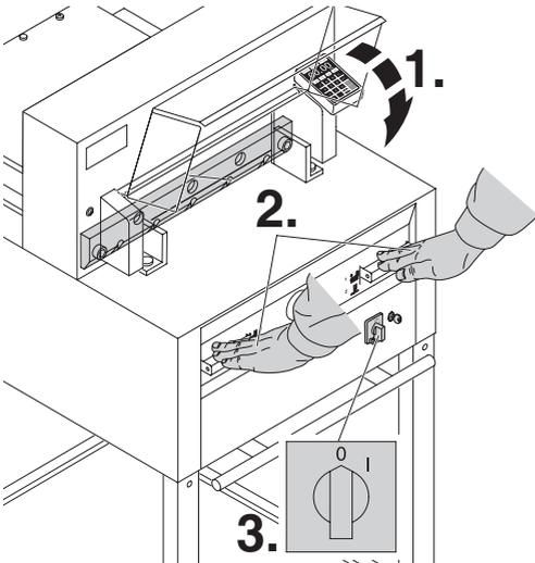
Refermer le carter avant (1.). Amener la lame en position basse (2.) et l'immobiliser dans cette position en maintenant appuyée une des deux touches de la commande bi-manuelle.
