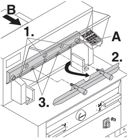
Visser en serrant légèrement 3 voire 2 (pour 4855) des 5 vis de lame avec rondelles (1.). Enlever le dispositif de changement de lame (2.) et visser en serrant légèrement les 2 vis de lame avec rondelles restantes (3.). Remettre le dispositif de changement de lame dans le porte-outils (B).
