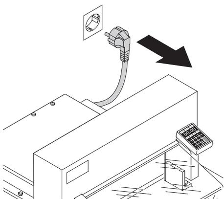
Débrancher l'appareil avant toute intervention ou démontage de panneaux !
