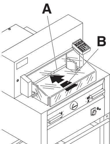
Un filet lumineux matérialise la ligne de coupe (**A**) (la lame coupe le papier sur le bord avant (**B**) du filet lumineux) ; à n'utiliser que lorsqu'il ne faut pas couper à une dimension bien précise.
