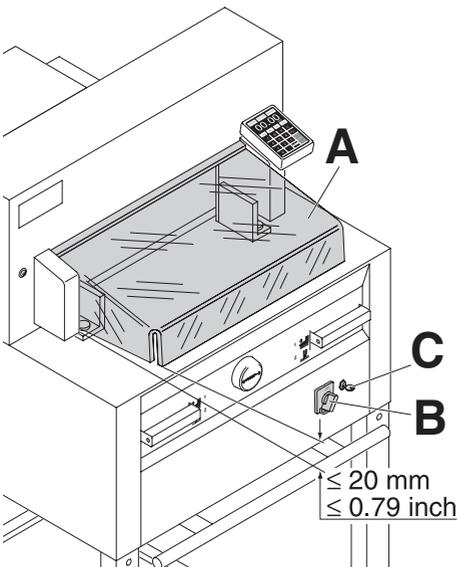
Avant tout travail avec la machine et après tout changement de lame, vérifier les systèmes de sécurité : carter de protection avant (A) (la distance entre la table et le capot doit être inférieure à 20 mm), interrupteur principal (B) et interrupteur à clé (C) !
