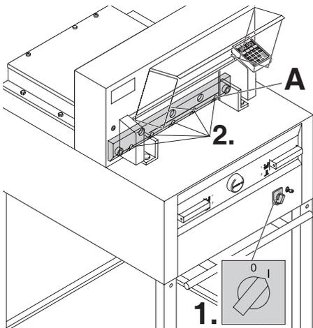
Basculer l'interrupteur principal (1.) en position "I". Après le retour de la lame en position haute, serrer énergiquement les 5 vis de lame.
