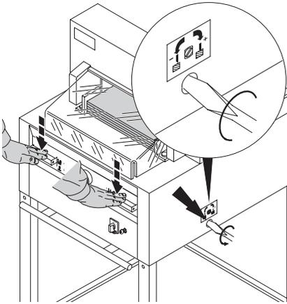
Couper une pile de papier pour tester la profondeur de coupe. Si la dernière ou plusieurs feuilles ne sont pas totalement coupées, tourner la vis de réglage de la profondeur de coupe (**A**) vers la droite, graduellement et toujours d'¼ de tour à la fois, jusqu'à ce que toutes les feuilles soient coupées.
