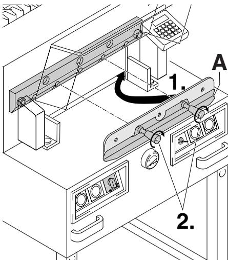
Austauschmesser mit aufgeschraubter Messerwechsell-einheit (A) ganz nach oben in den Messerträger schieben (1.) und dort Griffe festdrehen (2.).
