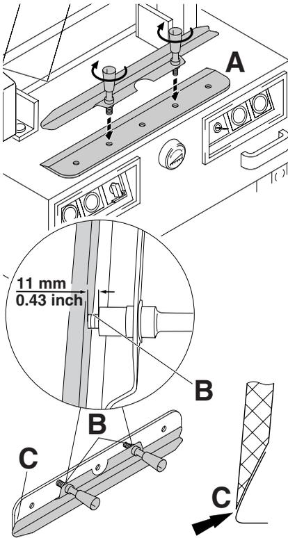
Austauschmesser vorsichtig aus Messerkasten nehmen und mit Messerwechsell-einheit verschrauben! (A).
