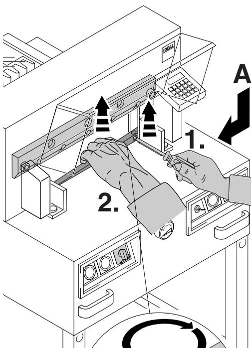
Schnittleiste mit einem kleinen Schraubendreher herausnehmen. Schnittleiste drehen, wenden oder bei Bedarf austauschen. (Die Schnittleiste kann acht mal verwendet werden).
