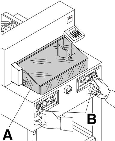
Die für Personen gefahrbringende Schneidbewegung ist durch eine schwenkbare Haube vorne (A) und eine Zweihandauslösung (B) abgesichert!
