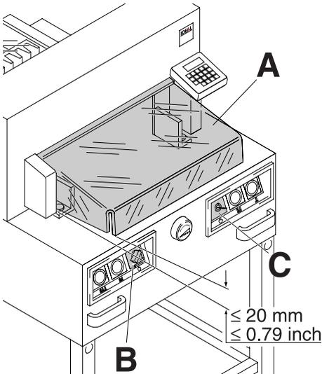
Vor jedem Arbeiten und nach jedem Messerwechsel, Abschaltfunktion von Haube vorne (A), (ist korrekt wenn Spalt zwischen Tisch und Haube vorne  $< 20$  mm beträgt) Hauptschalter (B) und Steuerung (C) überprüfen!
