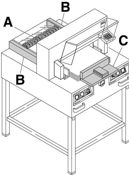
Papieranlage am Rückanschlag (A) und Seitenanschlag links oder rechts (B). Zum Verschieben von Papierstapeln, den mitgelieferten Stapelwinkel (C) benutzen. (Zum Drehen des Papierstapels erst Rückanschlag nach vorne fahren).
