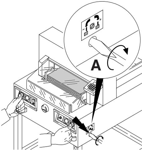
Zur Probe einen Papierstapel durchschneiden. Wenn das letzte Blatt oder mehrere Blätter nicht durchgeschnitten sind, die Messertiefgangsverstellung (A) nach rechts drehen, schrittweise immer eine  $\frac{1}{4}$  Umdrehung bis alle Blätter durchgeschnitten sind. (Nicht zu tief, Messerverschleiß)
