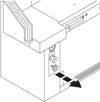
Tirare verso l'esterno il dispositivo di bloccaggio lama → la lama si sposta verso l'alto.
