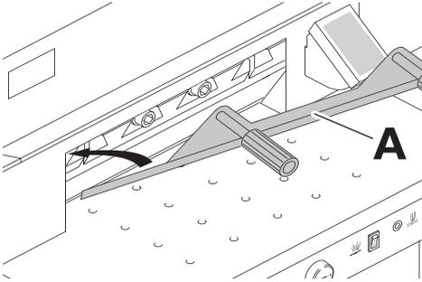
Montare la protezione della lama (A).
