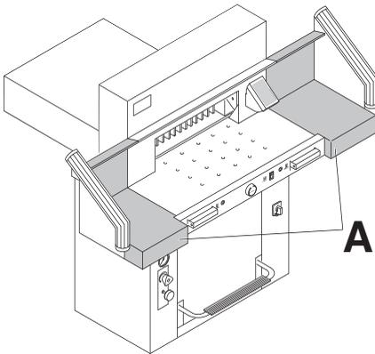
Viene fornita pronta all'uso. Sono disponibili (come accessorio) i piani (A) laterali d'appoggio destro e sinistro, con le relative istruzioni di assemblaggio.
