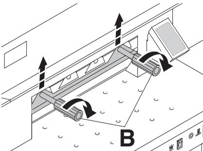
... posizionare e avvitare con le viti (B) nella parte superiore.
