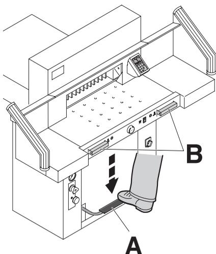
Nella fase di taglio la squadra di battuta pressa automaticamente. Con il pedale (A) la carta può essere pressata in avanti. Il taglio viene attivato premendo contemporaneamente entrambi i pulsanti del sistema di comando bimanuale (B).
