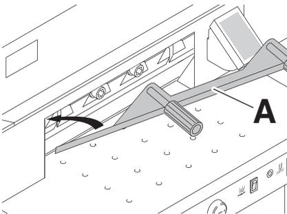
Montare la lama con la lama di sicurezza (A) ...
