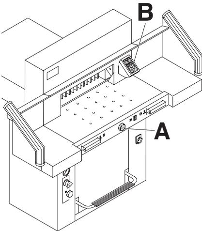
La graduazione è fatta manualmente tramite la leva con l'anello graduato (A) o per mezzo della programmazione (B) della misurazione di taglio. La misura sul display del comando (cm oppure inch) (B).
