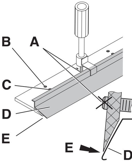
Avvitare la lama di sostituzione all'utensile di sostituzione lama come segue (D).
