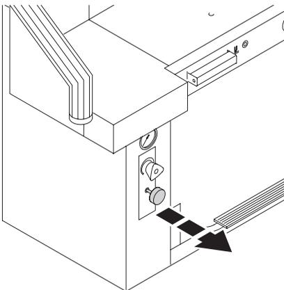
Tirare il dispositivo di bloccaggio → La lama si muove verso l'alto.
