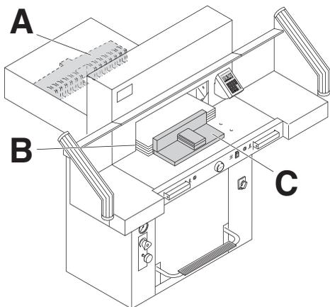
Posizionare la carta sul margine posteriore (A) e sul margine laterale sinistro o destro (B). Per muovere le pile di carta usare la guida di posizionamento carta (C). (Per girare la pila di carta far avanzare il margine posteriore).
