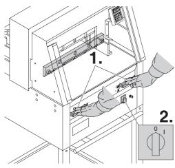
Messer durch Schnittauslösung nach unten fahren (1.) und eines der beiden Bedienelemente festhalten, dann Hauptschalter ausschalten (2.).
