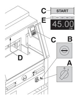
Hauptschalter auf Position "I" (A) Schlüssel für Steuerung einstecken und nach rechts drehen (B). Die Maschine ist betriebsbereit.
