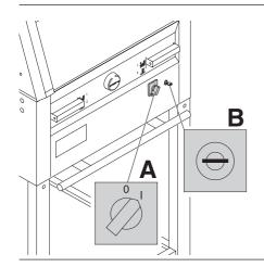
Hauptschalter auf Position "I"? (A) Steuerung eingeschaltet? (B) (Schlüssel nach rechts drehen). Schnittauslösung siehe Seite 21.
