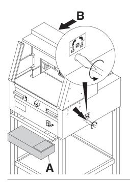
Messerverstellschraube bis zum Anschlag nach links drehen. (Schraubendreher im Werkzeugsatz (A) oder Werkzeughalter (B).
