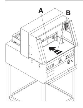
Schnittanzeige durch optischen Lichtstrahl (A) (Messer schneidet an der vorderen Kante (B) des Lichtstrahls, nur verwenden wenn kein genaues Maß geschnitten werden soll).
