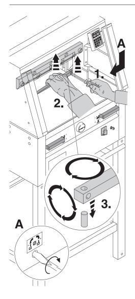
Schnittleiste mit einem kleinen Schraubendreher herausnehmen. Schnittleiste drehen, wenden oder bei Bedarf austauschen.
