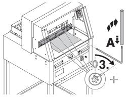
Mit dem Spezialschlüssel (A) die 3 Exzenter so weit nach unten drehen, bis das gesamte Papier durchgeschnitten ist (3.). (Messer darf dabei parallel nicht zu tief in die Schnittleiste eindringen).
