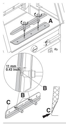
Austauschmesser vorsichtig aus Messerkasten nehmen und mit Messerwechseleinheit verschrauben! (A).
