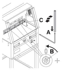
Die nun sichtbaren 3 Exzenter mit Spezialschlüssel und aufgestecktem Verlängerungsrohr (A) (im Werkzeugsatz) gegen Uhrzeigersinn zurückdrehen, Kerbe muß mit der Position "0" übereinstimmen (B).
