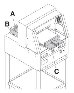
Papieranlage am Rückanschlag (**A**) und Seitenanschlag links oder rechts (**B**). Zum Verschieben von Papierstapeln, den mitgelieferten Stapelwinkel (**C**) benutzen. (Zum Drehen des Papierstapels erst Rückanschlag nach vorne fahren).
