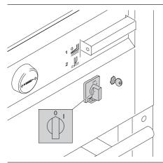
Messer- und Schnittleistenwechsel nur bei abgeschaltetem Hauptschalter!
