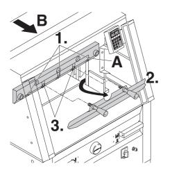
3 (bzw. 2 bei 4860) der 5 Messerschrauben leicht festschrauben (1.),
