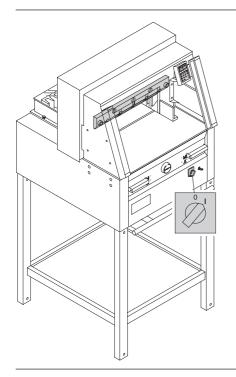
Den Spezialschlüssel entfernen. Hauptschalter so lange einschalten bis das Messer in oberster Stellung ist.
