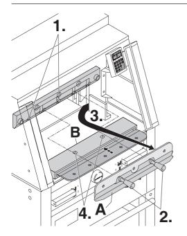
Die restlichen 2 Messerschrauben 4860 bzw. 3 Messerschrauben 5260, 6660 herausdrehen (1.) und die Griffe der Messerwechselvorrichtung (A) vorsichtig etwas lockern (2.) Das Messer nach unten entnehmen (3.). Messer in den dafür vorgesehenen Messerkasten (B) legen und festschrauben (4).
