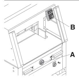
Die Maßeinstellung erfolgt manuell über das Handrad (A) oder über die Programmierung (B) des Schnittmaßes.
