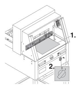
Alle Werkzeuge entfernen und Papier auf die ganze Breite des Schneidbereichs legen (1.). Hauptschalter in Position "I" bringen (2.).
