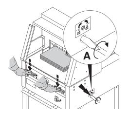
Zur Probe einen Papierstapel durchschneiden. Wenn das letzte Blatt oder mehrere Blätter nicht durchgeschnitten sind, die Messertiefgangsverstellung (A) nach rechts drehen, schrittweise immer eine ¼ Umdrehung bis alle Blätter durchgeschnitten sind. (Nicht zu tief, Messerverschleiß)
