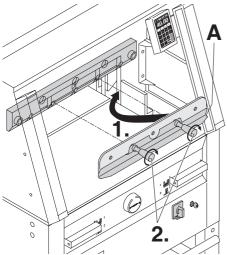
Austauschmesser mit aufgeschraubter Messerwechselvorrichtung (A) ganz nach oben in den Messerträger schieben (1.) und dort Griffe festdrehen (2.).
