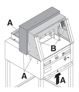
Gefahrbringende Maschinenteile sind durch Verkleidungen (**A**) abgedeckt!
