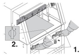
Messer durch Schnittauslösung nach unten fahren (1.) und einen der beiden Betätiger festhalten, dann Hauptschalter auf "0" stellen (2.).
