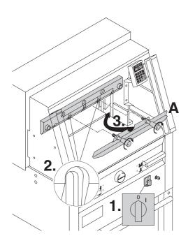
Hauptschalter auf Position "0" stellen. (1.) Die beiden Messerschrauben an den Langlöchern herausdrehen (2.), Messerwechselvorrichtung (A) ansetzen und fest verschrauben (3.).
