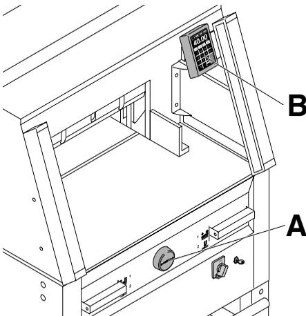
Размер задается рукояткой заднего упора (A), либо программированием с помощью клавиатуры (B)
