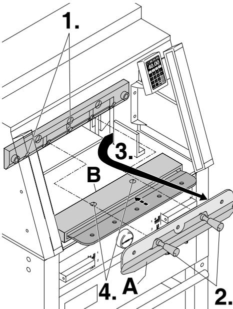
Открутите 2 винта, крепящие нож, (1.) в IDEAL 4860 и 3 винта, крепящие нож, (1.) в IDEAL 6660. Немного ослабьте рукоятки (2.) приспособления для смены ножа (A) и удалите нож вниз из машины (3.). Поместите нож в защитный футляр (B) и закрутите винты (4.).
