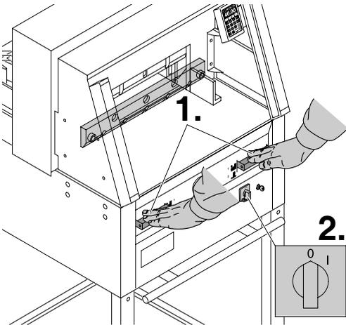
Опустите нож в нижнее положение, нажав обе Actuators-рукоятки (1.). Удерживая нажатой одну из Actuator-рукояток, выключите главный выключатель (2.).
