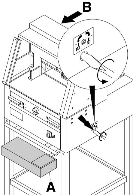
Поверните винт регулировки глубины реза влево до упора. (Отвертка находится в наборе инструментов (A) или в держателе инструментов (B)).
