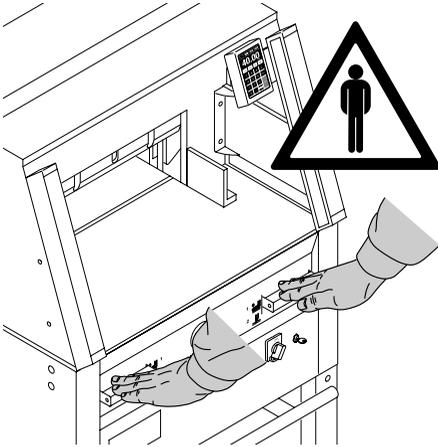
Машина предназначена для реза стопы бумаги в соответствии с задаваемым размером. Конструкция машины предусматривает работу только "одним оператором"!
