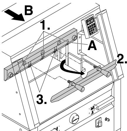
Слегка закрутите 3 (IDEAL 4860 имеется 2) из 5 крепящих нож винтов с шайбами (1.). Удалите приспособление для смены ножа (2.). Слегка закрутите остальные, крепящие нож, винты с шайбами (3.).
