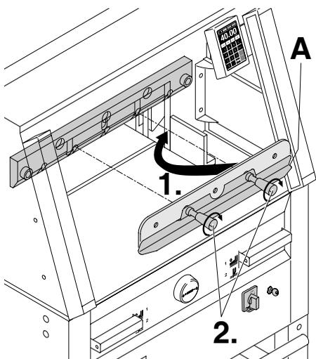
Поместите заменяемый нож с установленным приспособлением для смены ножа (A) (1.), в держатель ножа и сдвиньте его вверх до упора и закрутите рукоятки (2.).
