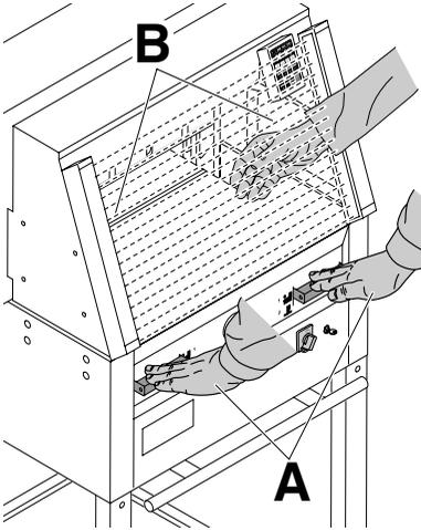
Процесс резки представляет опасность для оператора, поэтому защита производится системой управления, двумя руками (A) и защитным световым барьером (B).
