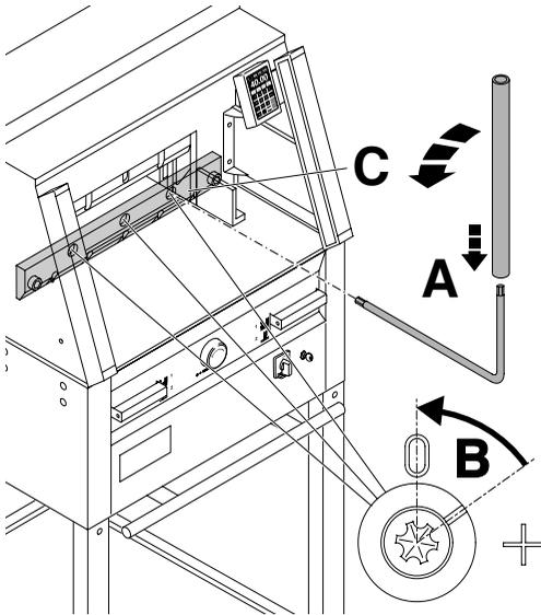
Видны 3 эксцентрика. Их надо повернуть против часовой стрелки в положение "0" специальным ключом, используя трубку - удлинение (A) (в наборе инструментов). Прорезь должна соответствовать положению "0" (B).
