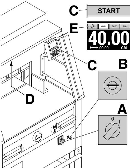
Установите сетевой выключатель в положение "I" (A).
