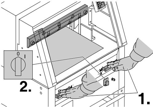
Опустите вниз нож, нажав обе кнопки (1.). Удерживая одну из кнопок нажатой, выключите основной выключатель (2.).
