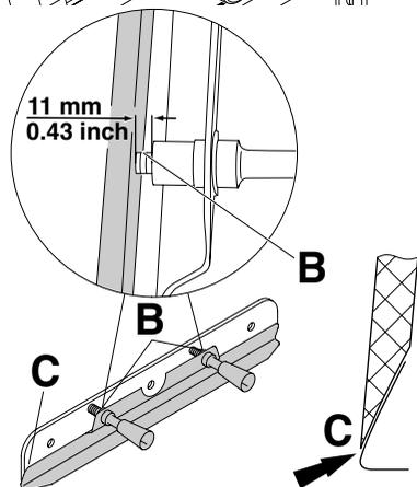
Осторожно выложите заменяемый нож из ящика и вкрутите рукоятки приспособления для замены ножа следующим образом: (A)
