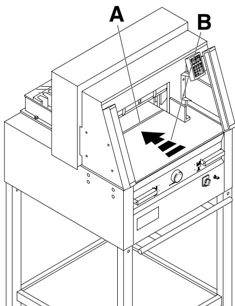
Оптический индикатор показывает линию реза (А). Нож режет по передней кромке светового луча (В). (Ориентируйтесь на световой луч лишь тогда, когда точность реза не нужна).
