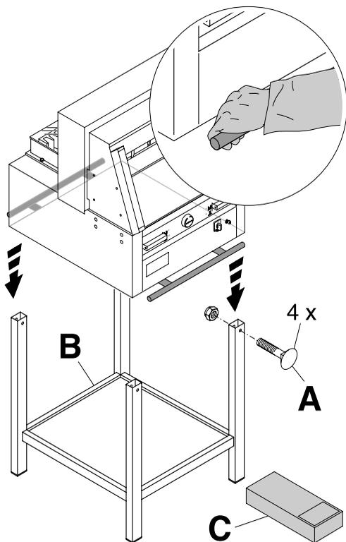
Чтобы поднять аппарат с поддона и поставить на станину необходимо 4 сильных человека. Закрепите 4 винтами с гайками (А). Положите на станину полку (В). (Детали и инструменты находятся в наборе инструментов (С)).
