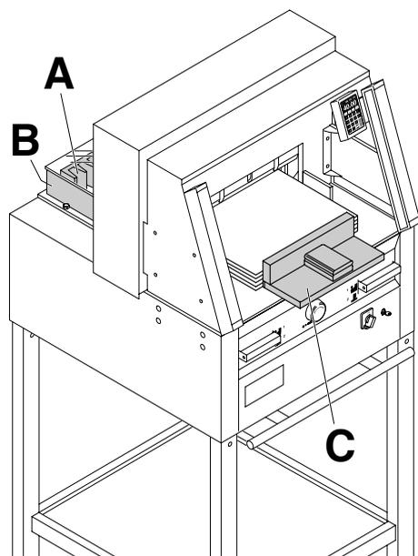
Установите бумагу к заднему упору (А) и боковым упорам слева или справа (В). Для перемещения бумаги используйте, поставляемый сталкиватель стопы (С). (Двигайте задний упор вперед, чтобы подвинуть стопу бумаги).
