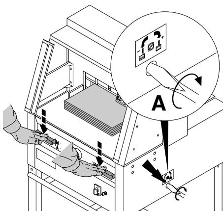
Разрежьте стопку бумаги для проверки. Если последний лист не разрезался, поверните регулировочный винт глубины опускания ножа (А) вправо, поворачивайте постепенно 1/4 оборота пока не прорежит всю стопку. (Не опускайте его слишком низко, иначе нож быстро затупится).
