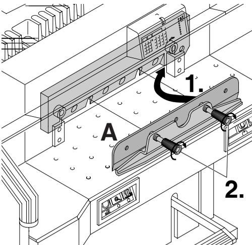
Introduire la lame neuve avec le dispositif de changement de lame (A) dans le porte-lame (le plus haut possible) (1.). Serrer les poignées pour bloquer la lame sur le porte-lame (2.).
