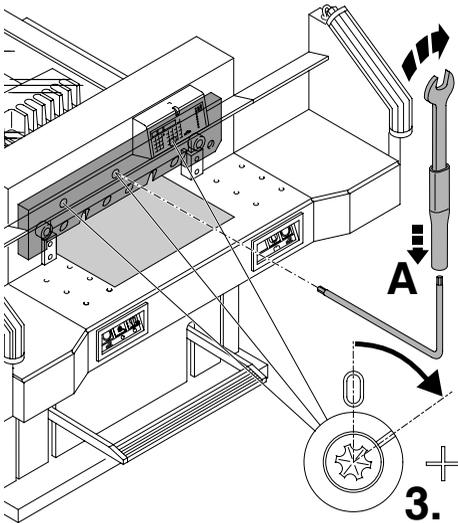
A l'aide de la clé spéciale, tourner les 3 comes vers le bas (3.) usqu'à ce que le papier soit coupé sur toute sa longueur (la lame doit se positionner parallèlement à la réglette, mais ne doit pas s'enfoncer trop dans celle-ci).
