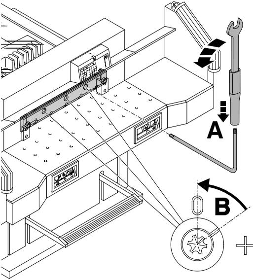
Tourner les 3 comes maintenant visibles à l'aide de la clé spéciale et du tube de prolongement (A) (outils dans la trousse à outillage), dans le sens contraire des aiguilles d'une montre. L'encoche doit s'aligner sur la position "0" (B).
