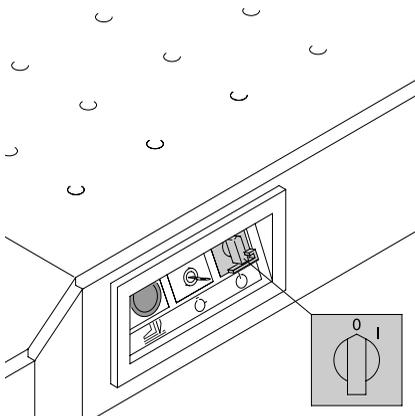
Le remplacement de la réglette ou de la lame ne peut se faire que lorsque l'interrupteur principal est en position d'arrêt !
