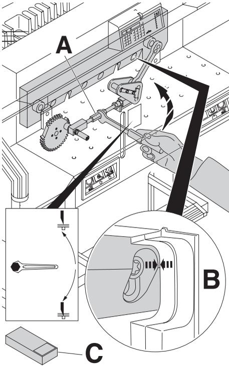
Tourner la vis de réglage (A) de profondeur de coupe vers le haut, jusqu'à ce que l'évidement de la vis de lame se trouve en face de l'évidement du bâti (B).
