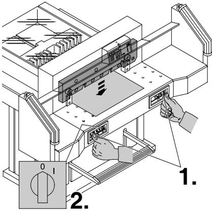
Amener la lame en position basse (1.) et l'immobiliser dans cette position en maintenant appuyé un des deux boutons de la commande bi-manuelle, et en basculant l'interrupteur principal sur "0" (2.).
