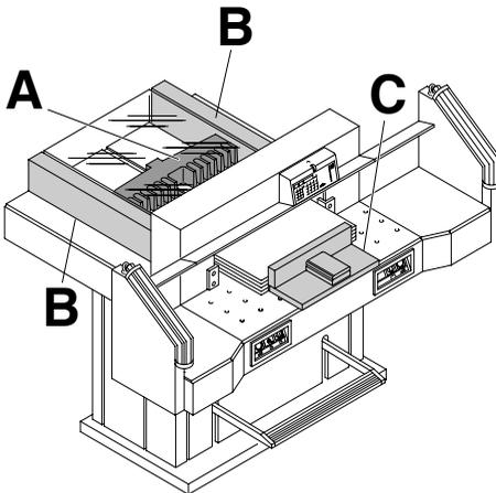
Positionner le papier contre la butée arrière (A) et la butée latérale droite ou gauche (B). Pour déplacer la pile de papier, utiliser la cale de taquage (C) fournie (pour tourner la pile de papier, déplacer d'abord la butée arrière vers l'avant).
