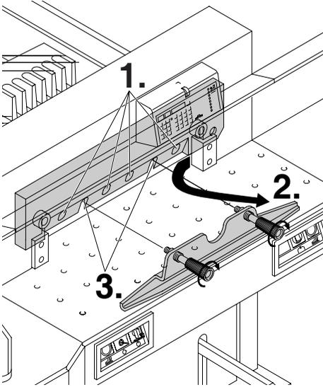
Visser en serrant légèrement 4 des 6 vis de lame avec rondelles (1.). Enlever le dispositif de changement de lame (2.) et visser en serrant légèrement les 2 vis de lame avec rondelles restantes (3.).
