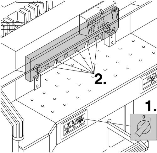
Basculer l'interrupteur principal (1.) en position "I". Après le retour de la lame en position haute, serrer énergiquement les 6 vis de lame.
