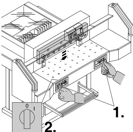
Amener la lame en position basse (1.) et l'immobiliser dans cette position en maintenant appuyé un des deux boutons de la commande bi-manuelle. Basculer ensuite l'interrupteur principal sur "0" (2.).
