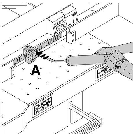
Le support de la butée arrière nécessite un graissage hebdomadaire avec la pompe à graisse. Faire avancer la butée arrière tout à l'avant pour effectuer ce graissage. Graisser le support de butée arrière (A). (ne pas utiliser d'huile ou de graisse qui se durcit).
