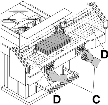
En ce qui concerne les éléments de coupe en mouvement, les cellules photoélectriques (D) et une commande bi-manuelle temporisée (C) vous en protègent !
