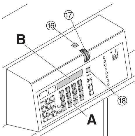
Le réglage à la dimension voulue est obtenu manuellement ⑰ grâce au déplacement du bouton moleté (A) ou automatiquement, par l'intermédiaire de la commande ⑱ et la programmation des dimensions souhaitées ⑲. La dimension est affichée sur l'écran de la commande (en cm ou pouces) (B).
