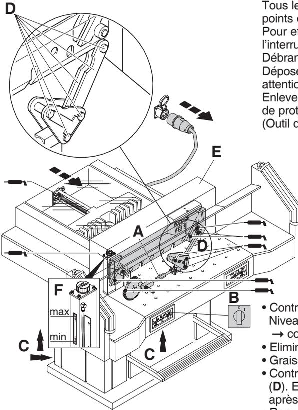
Tous les 6 mois, graisser tous les autres points de graissage (voir schéma ci-dessous). Pour effectuer cette opération, basculer l'interrupteur principal sur "0" (B). Débrancher la machine. Déposer le carter supérieur (E) → faire attention aux câbles. Enlever les plaques inférieures et le panneau de protection en bois à l'arrière. (Outil dans la trousse à outillage).
