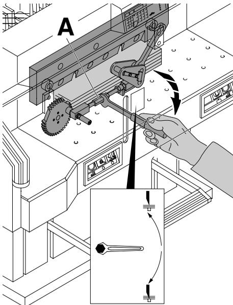
Couper une pile de papier pour tester la profondeur de coupe. Si la dernière ou plusieurs feuilles ne sont pas totalement coupées, tourner la vis de réglage de la profondeur de coupe (A) vers la dessus, graduellement et toujours d'1/12 de tour à la fois, jusqu'à ce que toutes les feuilles soient coupées.
