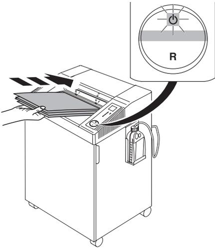
**RU** Останавливается автоматически при превышении количества уничтожаемой бумаги. Реверс включается автоматически, если произошел затор бумаги. (Индикатор "ON/OFF"
