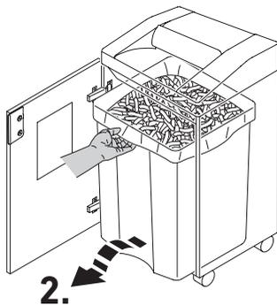
**RU** При заполнении пластикового мешка аппарат остановится автоматически. Должен загореться индикатор
