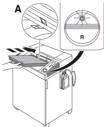
**RU** Бумага установлена по центру приемного устройства (фотодатчик) **(A)**
