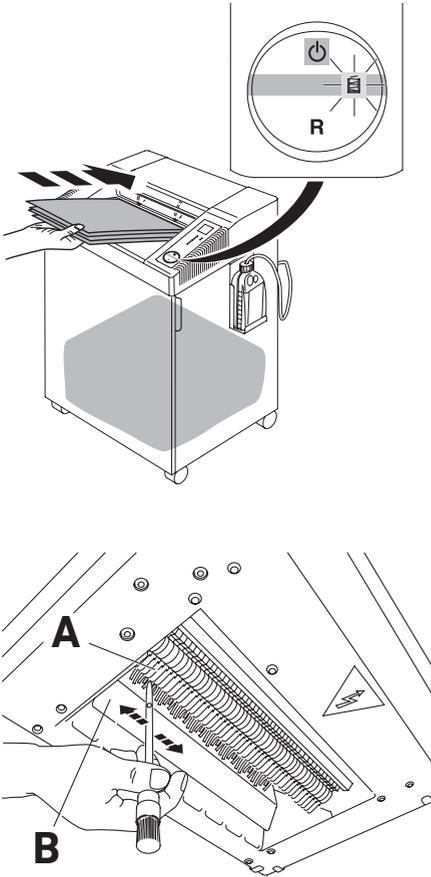
**RU** Отключите машину от сети. С помощью щетки удалите бумажные обрезки ножами (A) и клапаном (B). Смотрите рисунок, приведенный ниже.
