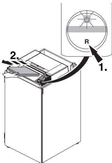
**DE Bei Bedarf:** Schalter "R" drücken, Papier entnehmen. (Maschine läuft nur kurz rückwärts, bei Bedarf mehrmals wiederholen).
