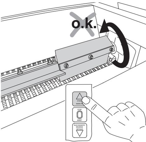
**DE** Dreht die Flügelwelle in die falsche Richtung → Drehfeld von einer Elektrofachkraft ändern lassen.
