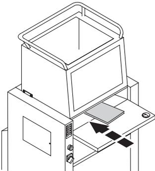
**RU Если машина остановилась,** сработал датчик перегрева. Прекратите работу примерно на 5-10 минут, для остывания.
