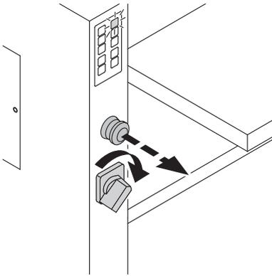
**RU При запуске машины главный переключатель должен стоять в положении "I". Кнопка экстренной остановки - отжата.**
