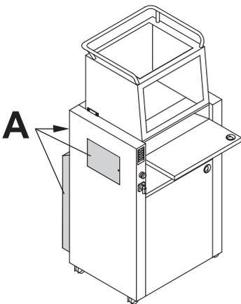
**RU** Все компоненты, которые могут представлять опасность для оператора, закрыты защитными крышками и снабжены дверцами (A).
